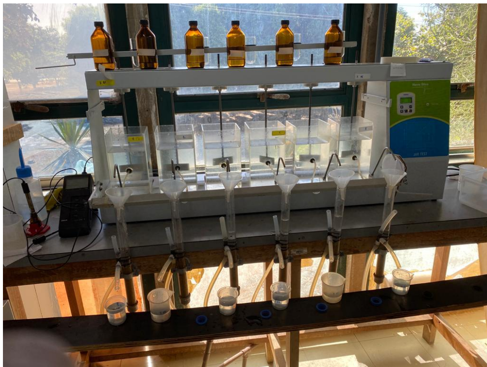
Figura 4.2 – Equipamento de teste de jarros adaptado para filtração direta.
