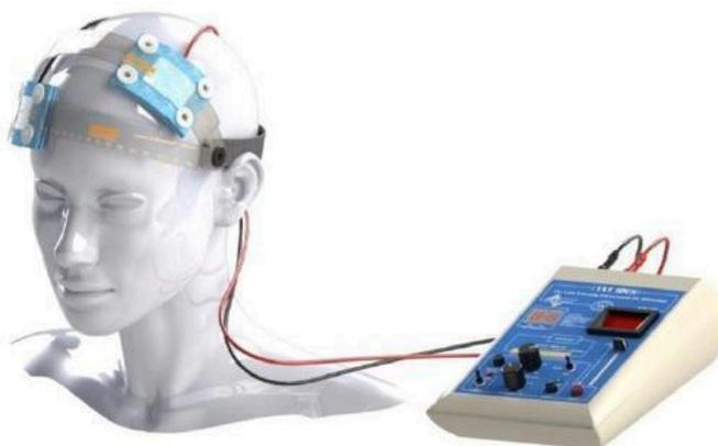
**Figura 1.** Equipamento de Estimulação Transcraniana por Corrente Contínua (ETCC). Nesta foto, encontra-se o posicionamento dos eletrodos referentes a estimulação anódica, ou seja, com o anodo localizado sobre o córtex motor primário e o catodo sobre a região da testa contralateral. Na estimulação catódica este posicionamento é invertido.
