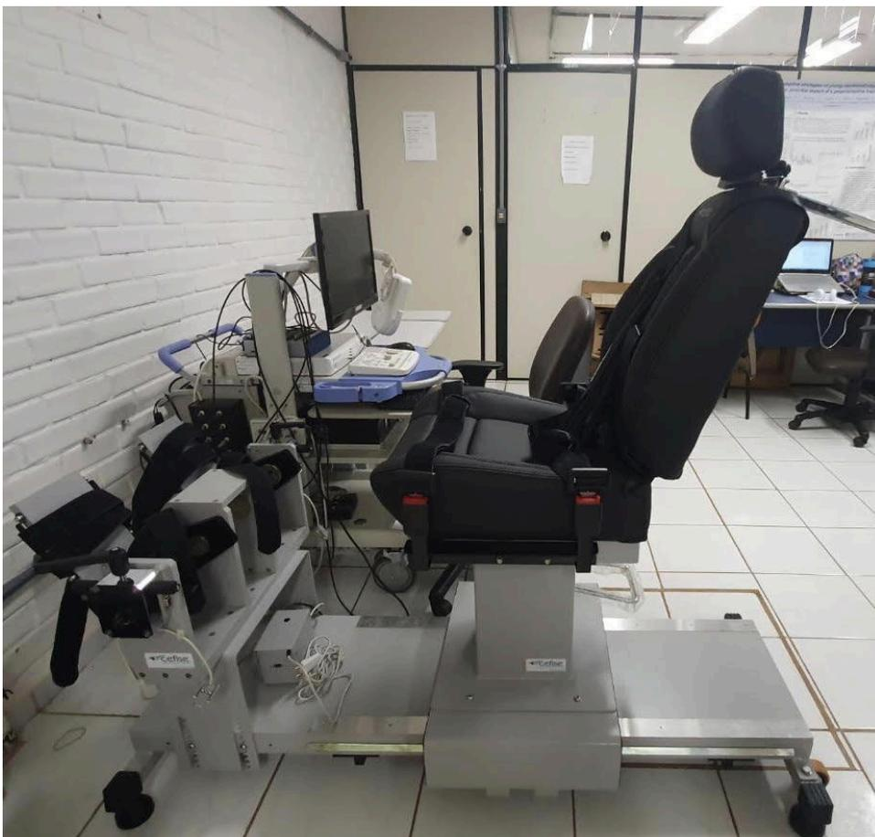
**Figura 13.** Suporte instrumentalizado para experimentos com reflexo H.
