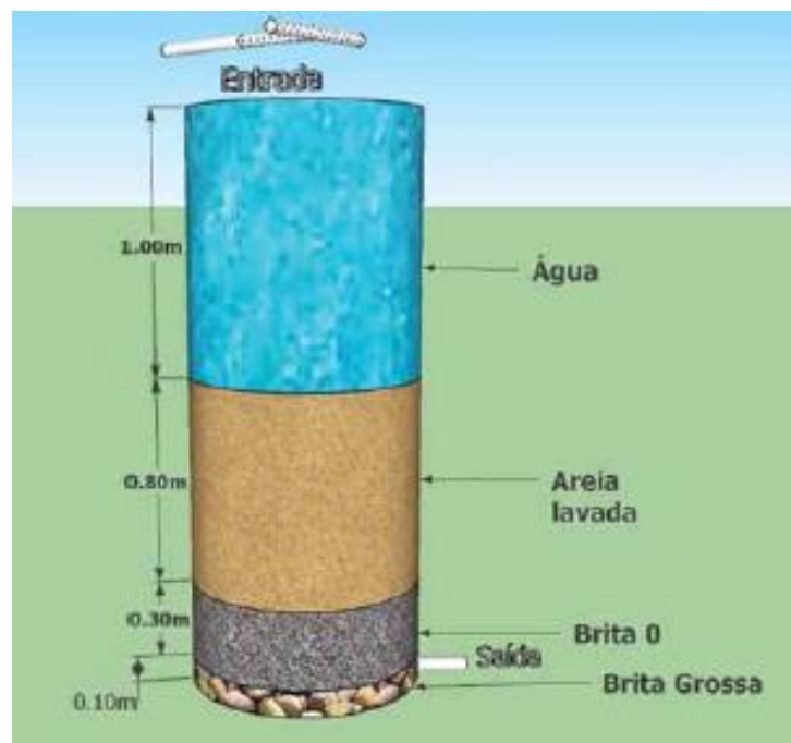
Figura 3.10: Esquema genérico do interior do filtro lento ilustrado pela EMATER-MG (Leal, 2016)
