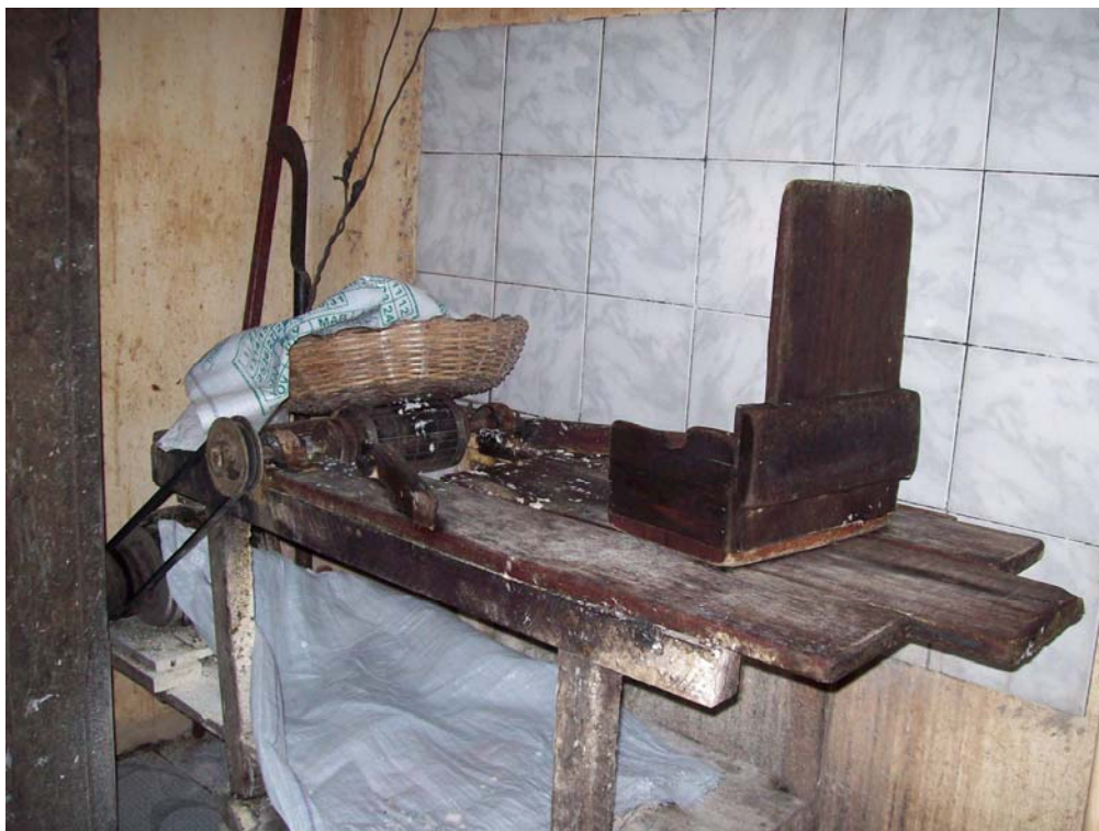
Prensa utilizada não só para pilar a massa de tapioca, mas serve também para ralar o coco
