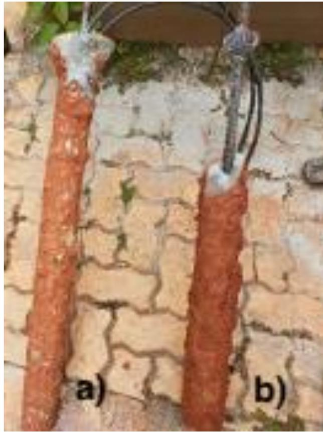
Figura A.11 – Grampos exumados após os ensaios de arrancamento, sem carregamento vertical. a) Grampo com 1 setor de reinjeção b) Grampo sem reinjeção
