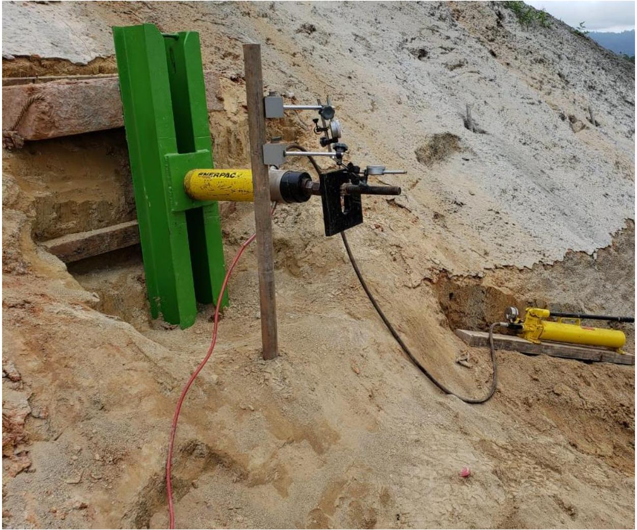
Figura 6.3 – Montagem de ensaio de arrancamento sub-horizontal no talude 1
