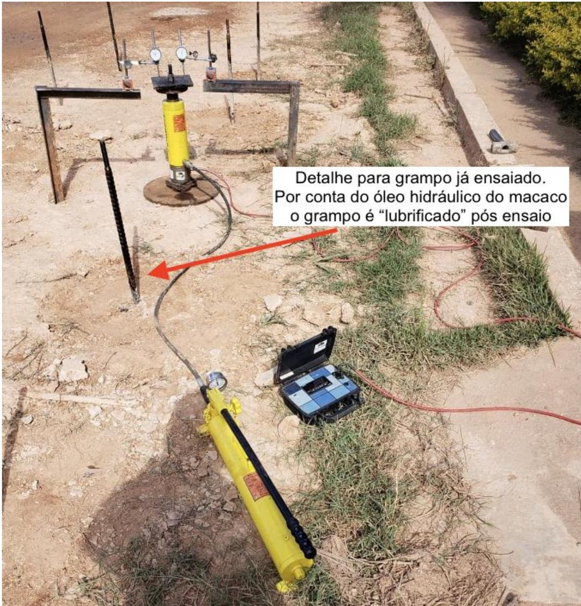
Figura 5.26. Detalhe de grampo após ensaio. Por conta da lubrificação interna do macaco vazado o grampo já ensaiado apresenta resquícios do óleo hidráulico, observado pela cor negra brilhante no grampo em destaque na imagem.
