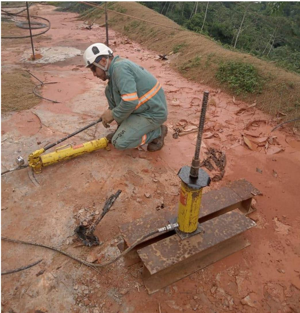
Figura 6.6 - Montagem de ensaio de arrancamento vertical no talude 2
