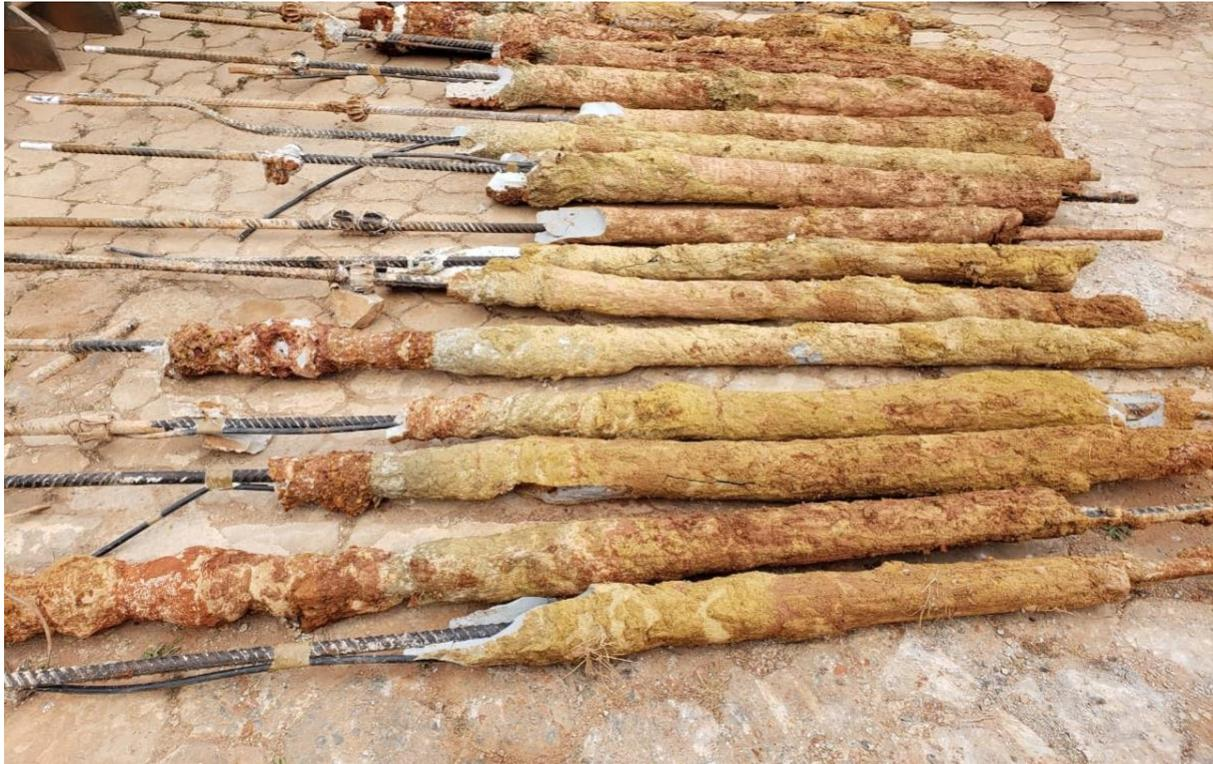
Figura 5.40. Detalhe dos grampos pós exumação. Os danos nos grampos foram principalmente no topo e na base de cada grampo, devido ao processo de içamento mecanizado.
