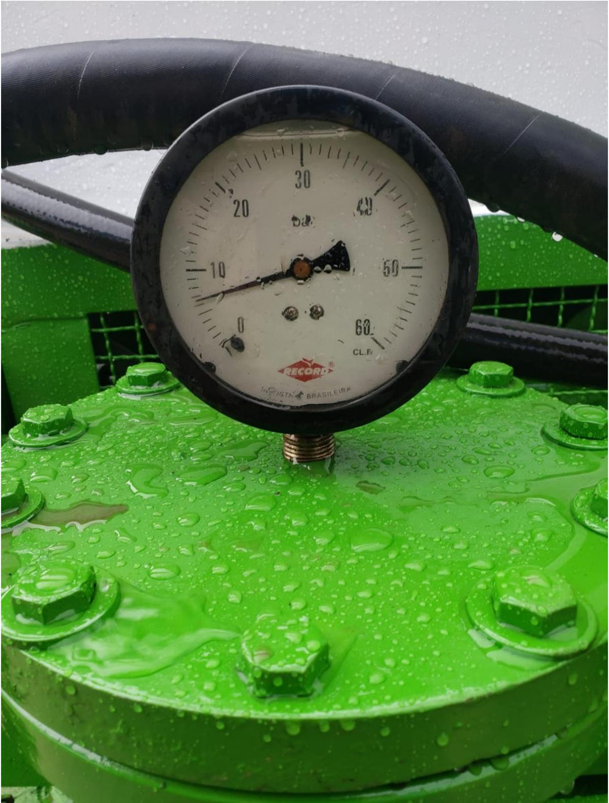
Figura 5.21 – Pressão de reinjeção dos grampos executados por meio da técnica de reinjeção setorizada, a pressão de abertura fica entre 3-5 vezes maior do que a pressão de injeção, para o caso do solo do campo experimental
