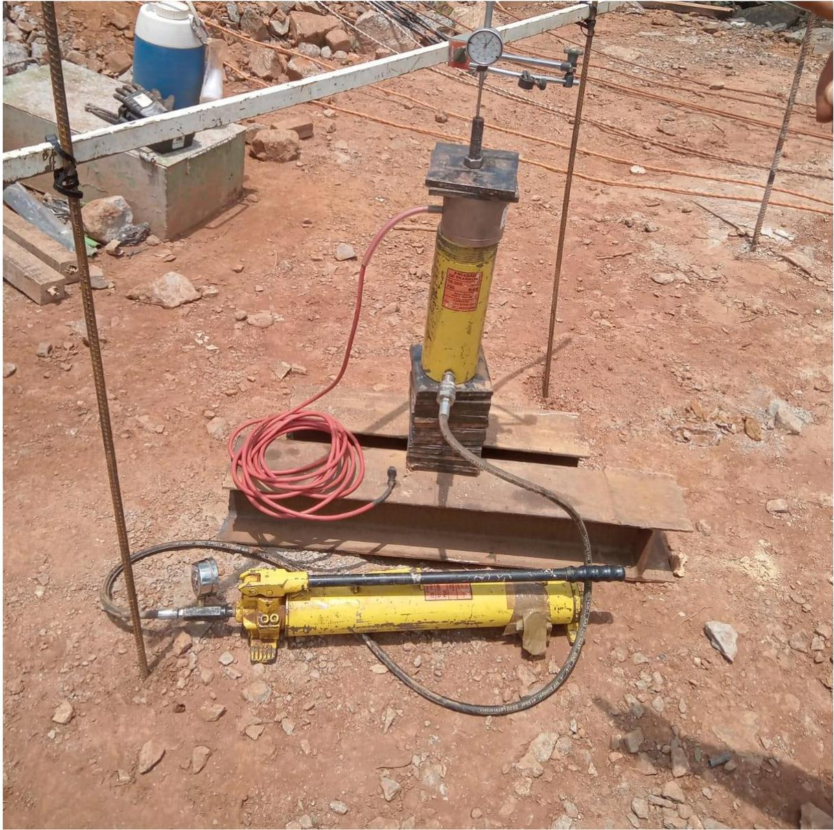
Figura 6.4 - Montagem de ensaio de arrancamento vertical no talude 1
