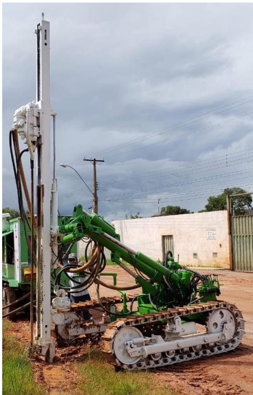
Figura 5.18 – Perfuratriz pneumática rotopercussiva para execução de grampos com circulação de ar
