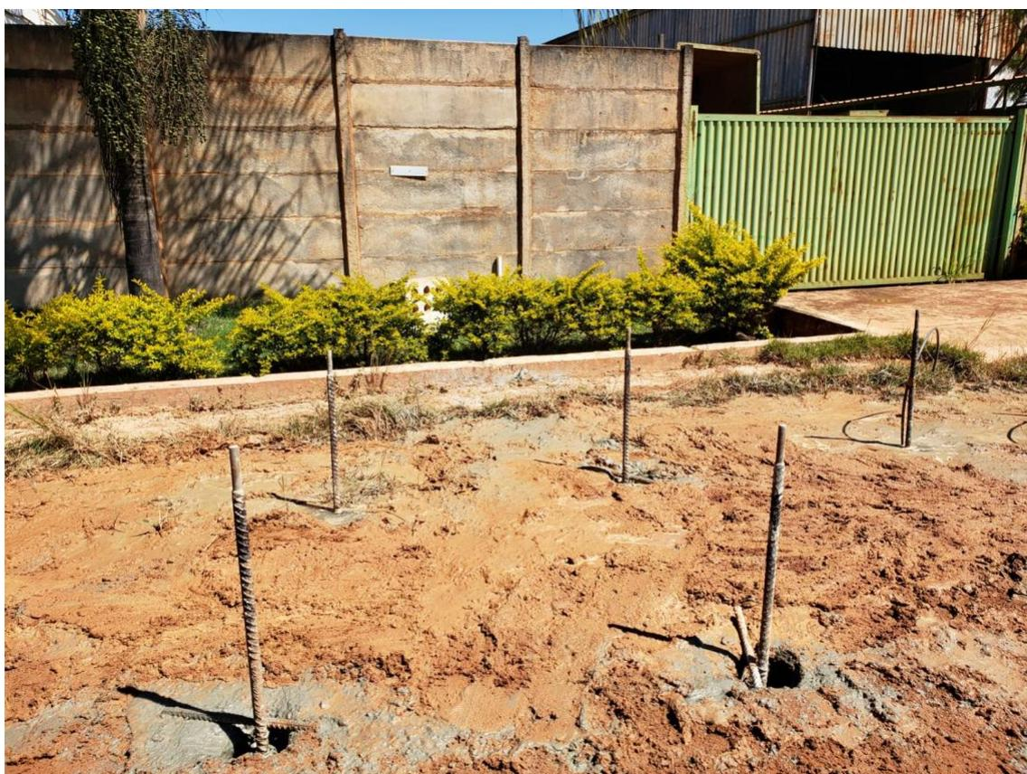
Figura 5.19 – Furos do campo experimental após procedimento de injeção
