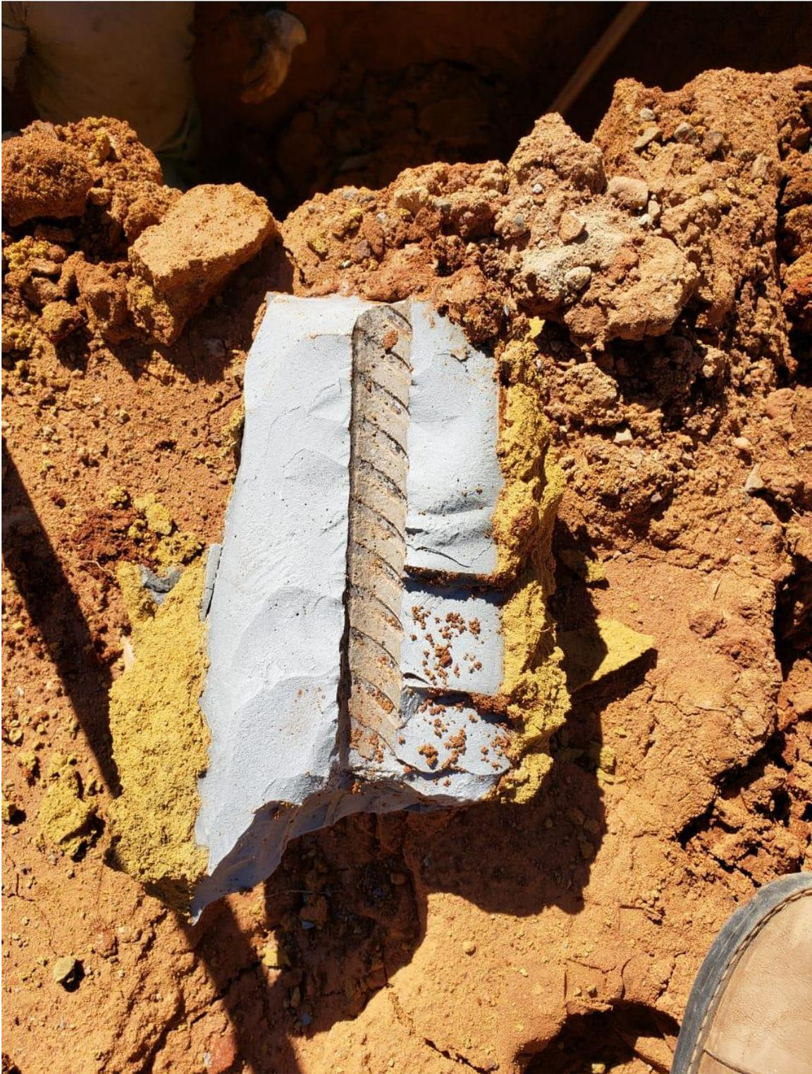
Figura 5.37. Detalhe de bainha de grampo exumado, em que a calda de cimento é íntegra, sem contaminação do solo circundante
