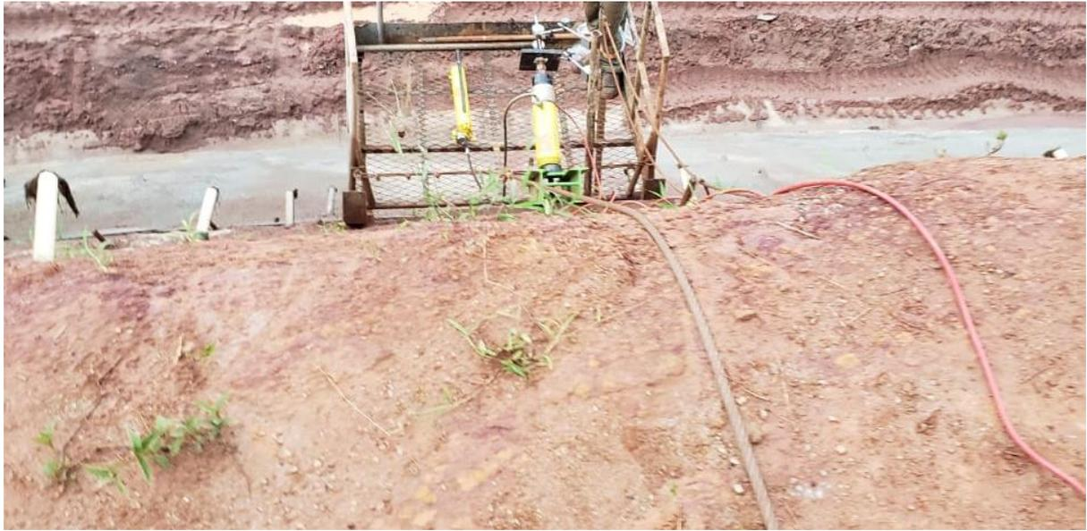
Figura 6.5 - Montagem de ensaio de arrancamento sub-horizontal no talude 2
