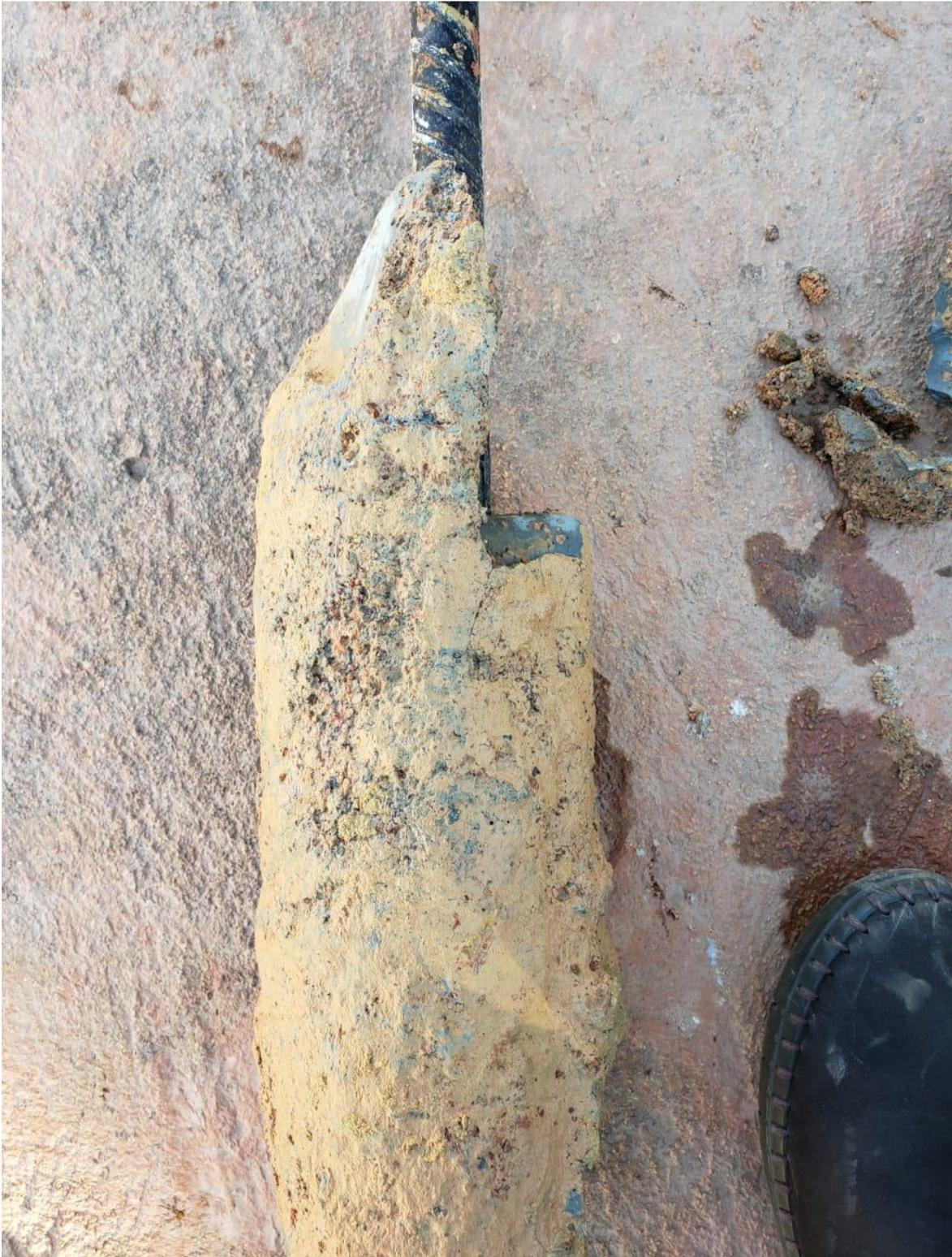
Figura 5.38. Detalhe de impregnação do solo circundante no exterior da bainha, com porção não possível de remover nem com limpeza à base d'água.
