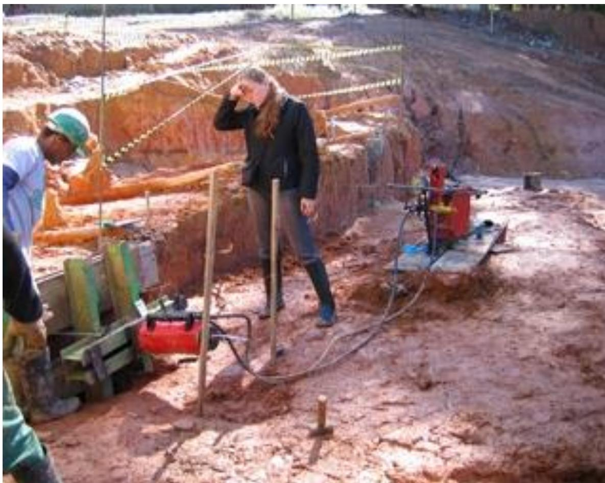
Figura 4.5. Montagem típica do ensaio de arrancamento. Os grampos tinham comprimento total de 4,0 m e comprimento livre de 1,0 m. Utilizou-se uma estrutura de suporte junto à face do talude
