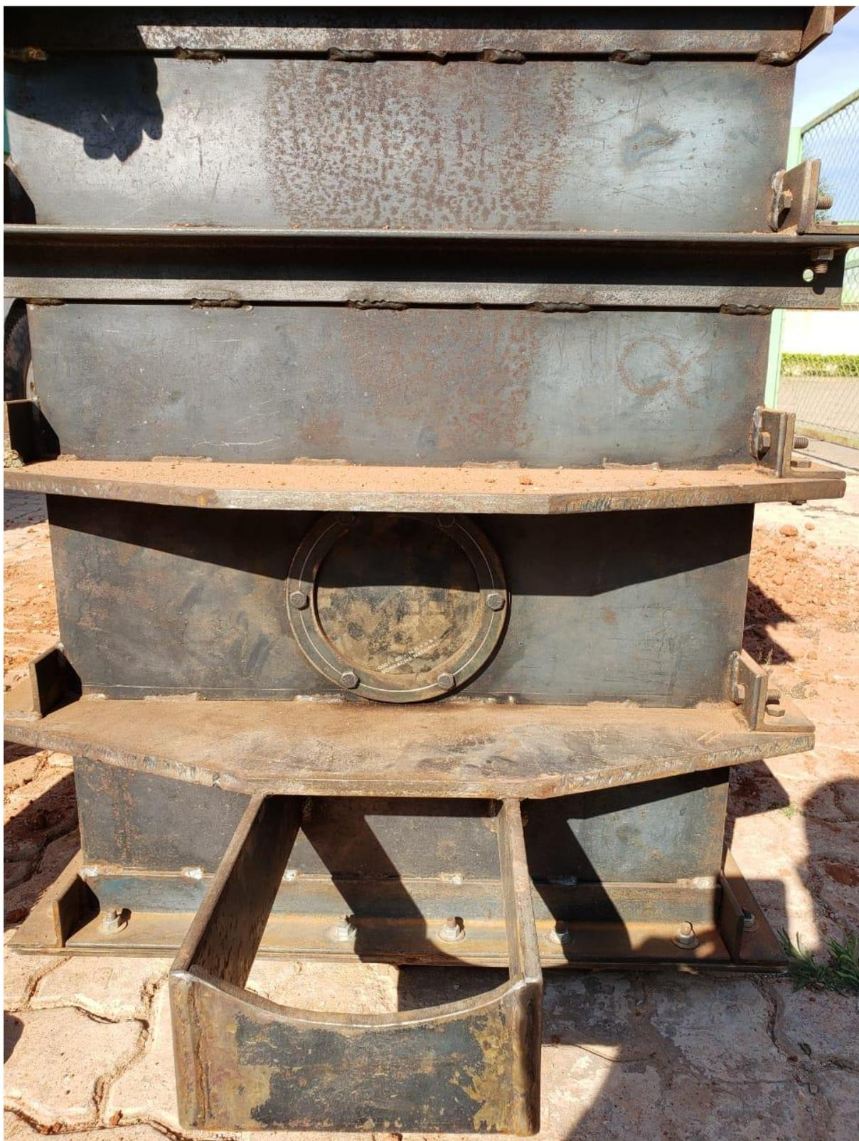
Figura A.5 – Detalhe da membrana utilizada para a caixa de cisalhamento
