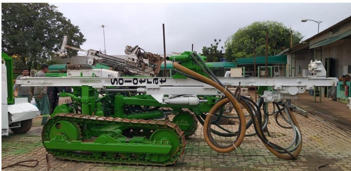
Figura 5.9 – Vista típica da perfuratriz rotopercussiva com ar como fluido de perfuração, com torre recolhida
