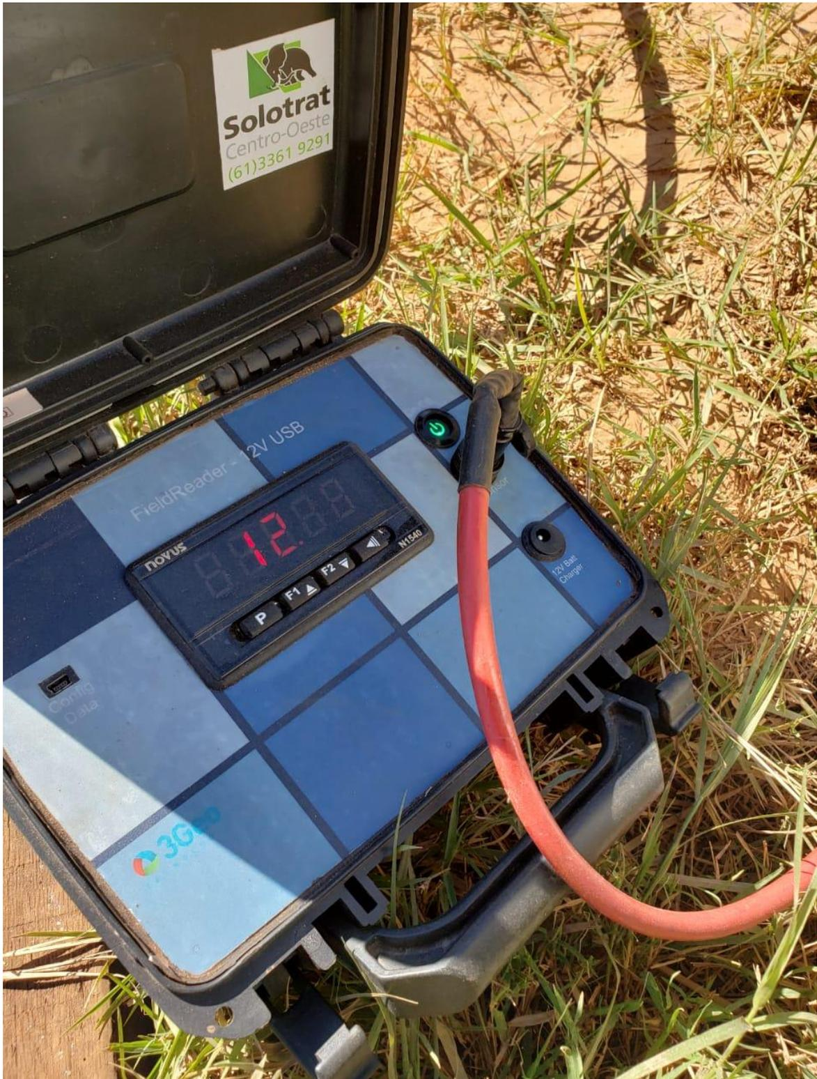
Figura 5.25. Detalhe da FieldReader 3Geo, com leitura de carga pico – grampo com reinjeção.
