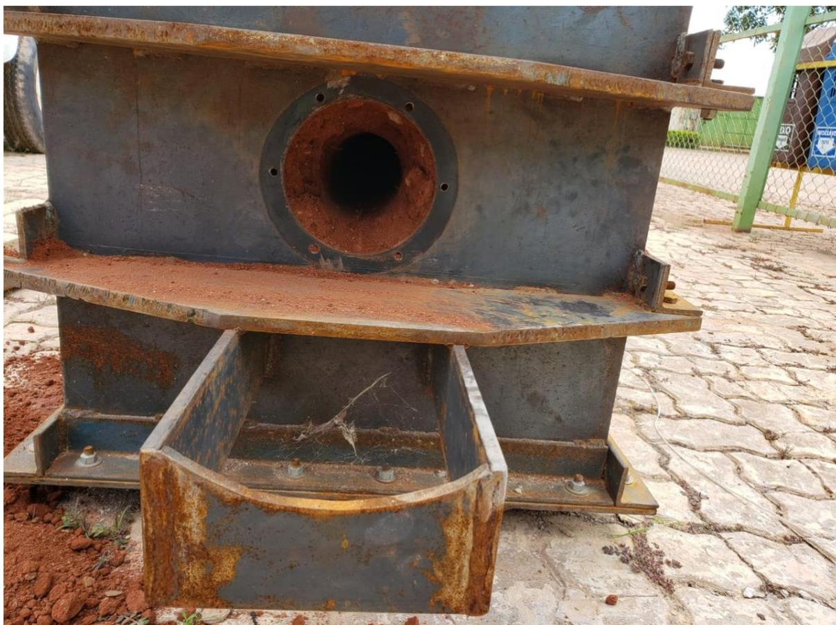
Figura A.4 – Detalhe do furo finalizado na caixa de cisalhamento
