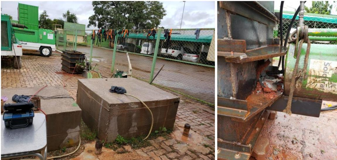
Figura A.9 – Ensaio de arrancamento no protótipo da caixa de cisalhamento
