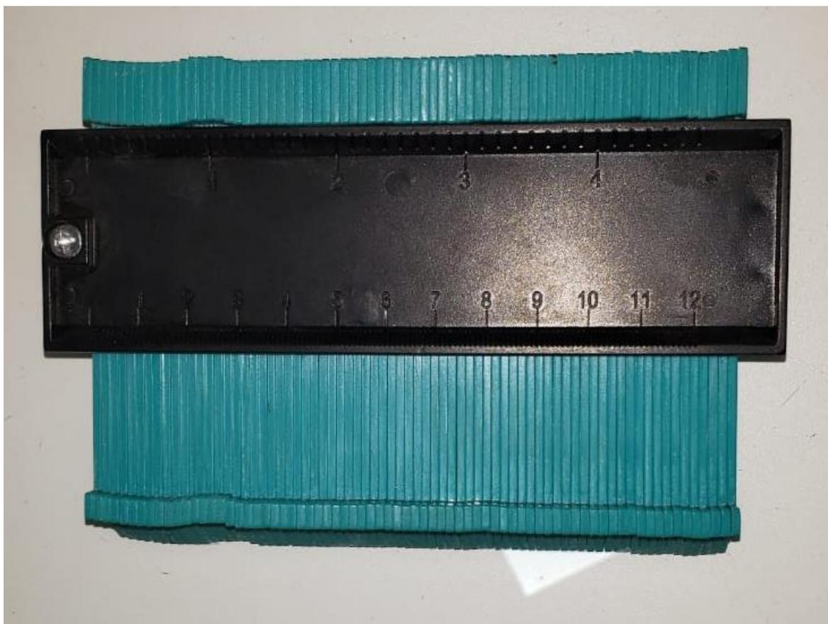
Figura 5.42. Perfilômetro para traçado dos perfis de rugosidade dos grampos
