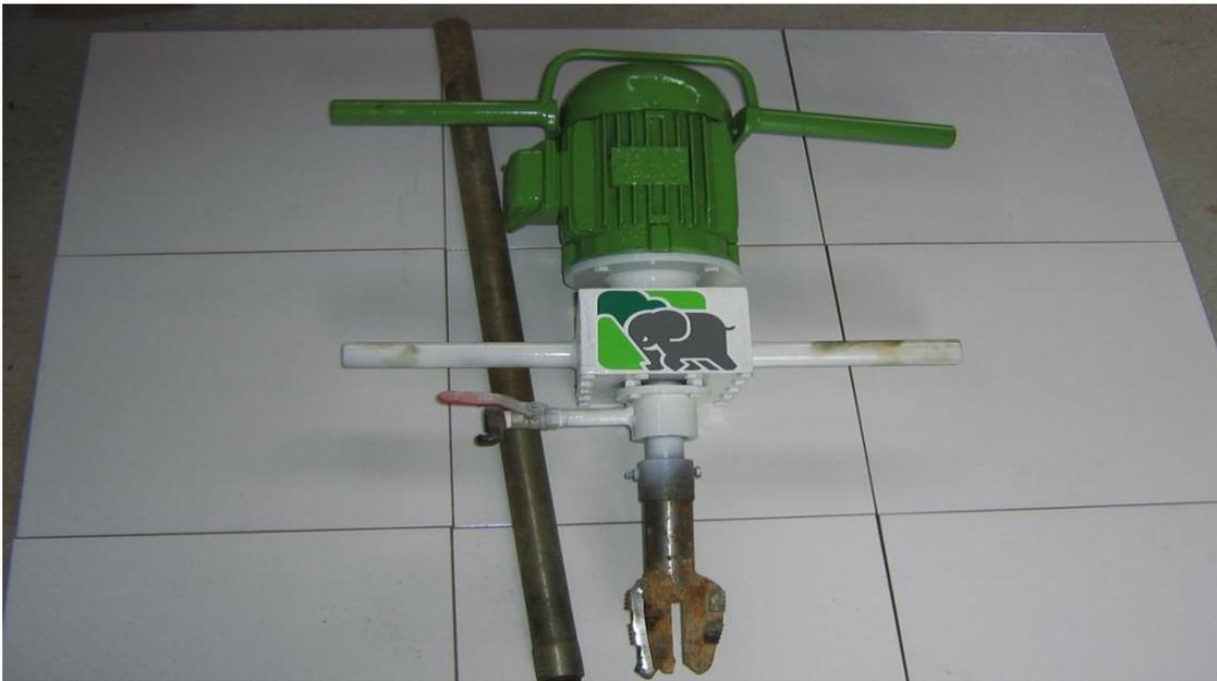
Figura 5.7 – Vista típica da perfuratriz rotativa com água como fluido de perfuração, com haste (à esquerda), bit de perfuração do tipo tricône e corpo da máquina, com motor fechado
