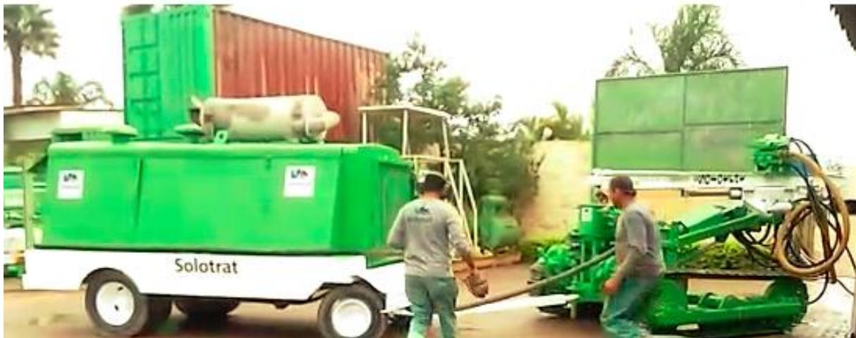
Figura 5.10 - Vista típica do conjunto perfuratriz-compressor, com uso de ar como fluido de perfuração, em deslocamento
