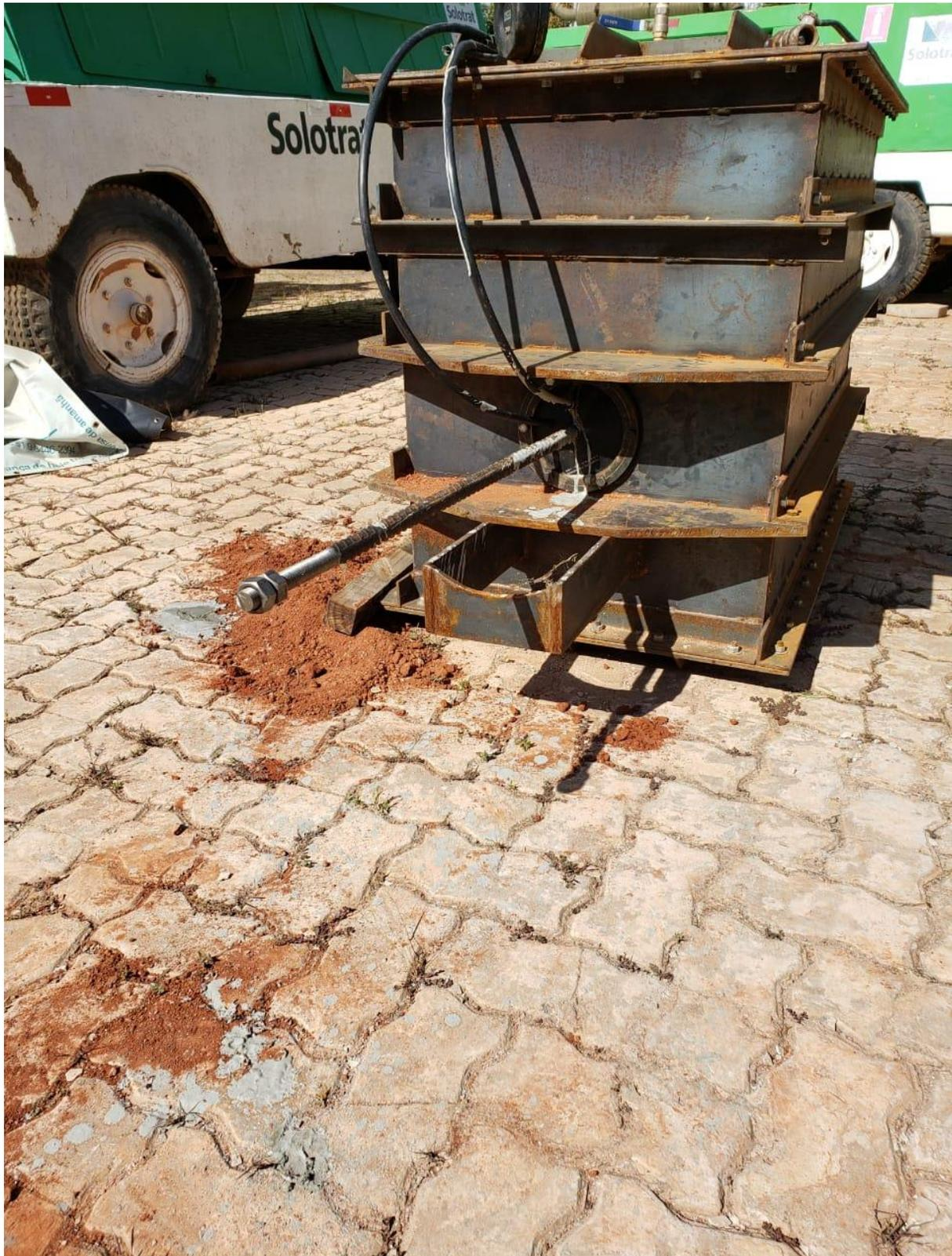
Figura A.8 – Reinjeção dos grampos piloto na caixa de cisalhamento
