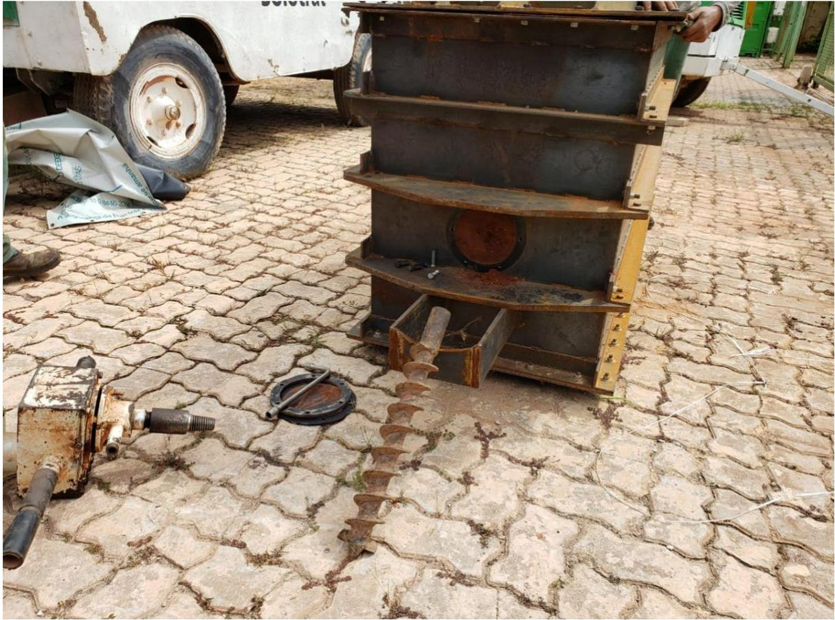
Figura A.3 – Detalhe do equipamento de perfuração para a execução dos grampos experimentais
