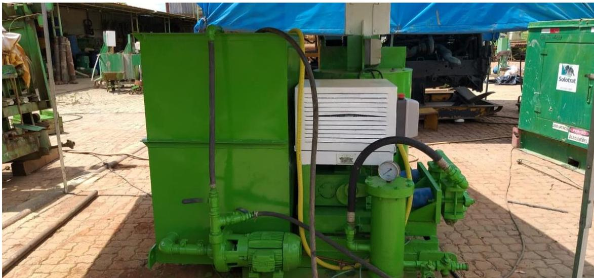
Figura 5.12 - Vista típica do misturador duplo com bomba de injeção acoplada
