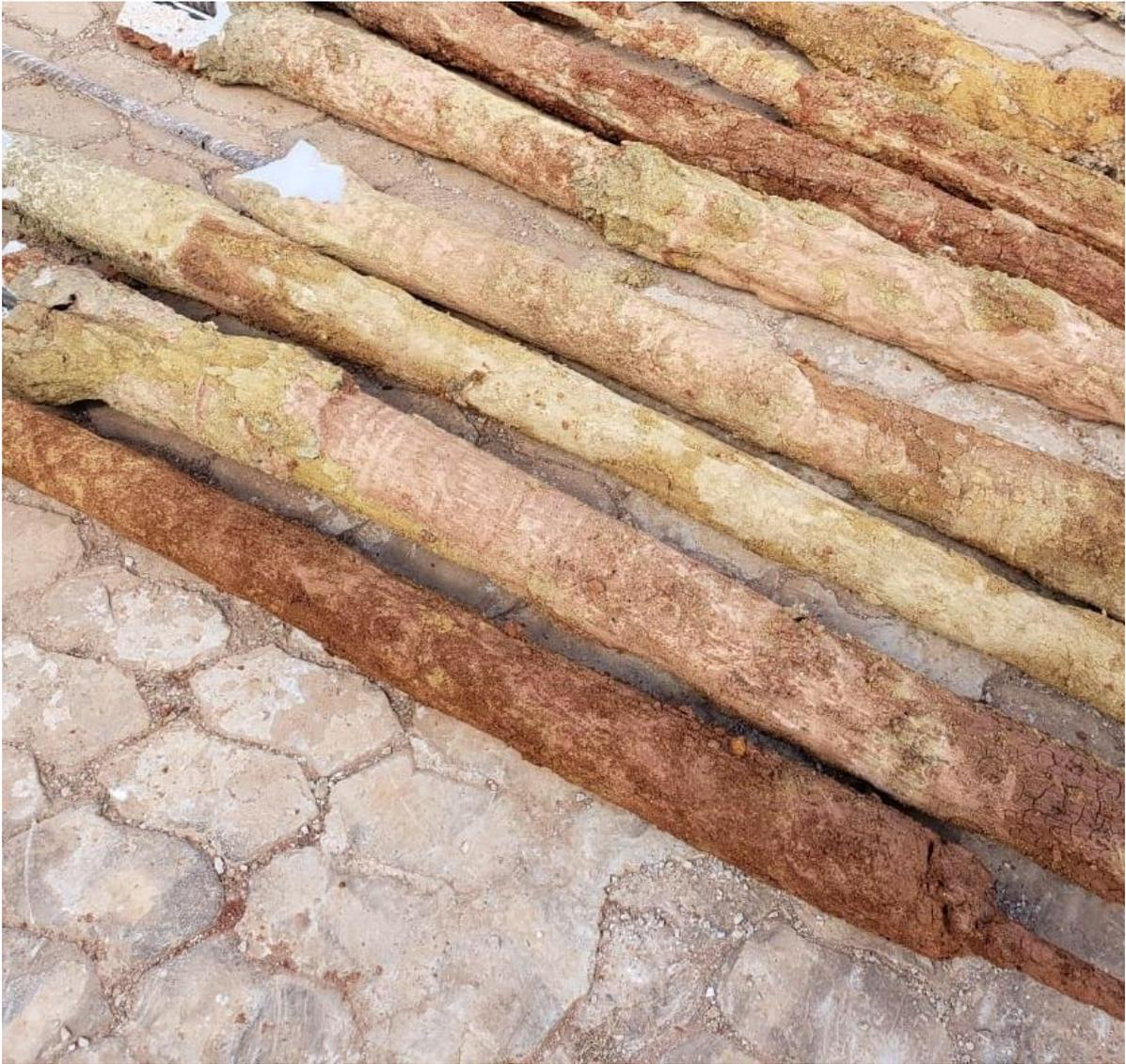
Figura 5.39. Detalhe dos grampos pós exumação. Os danos nos grampos foram principalmente no topo e na base de cada grampo, devido ao processo de içamento mecanizado
