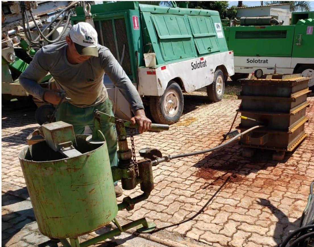
Figura A.7 – Injeção dos dos grampos piloto na caixa de cisalhamento
