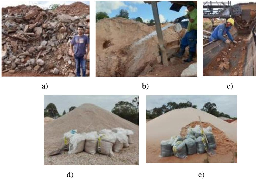
Figura 3.2. RCD-R a) Entulho sem tratamento, b) lavagem ao jato, c) remoção manual de elementos não desejadas, d) coleta de RCD-R pedregulho e e) coleta de RCD-R areia.
