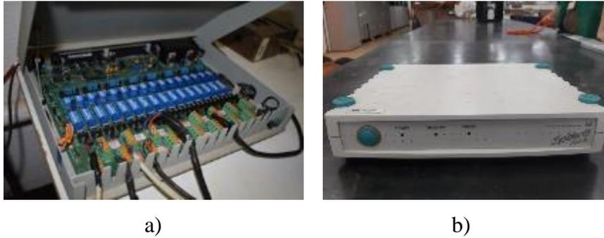
Figura 3.20. Sistemas de aquisição de dados a) LYNX modelo ADS0500-16-W ADS 2000 e b) Spider-8.0.
