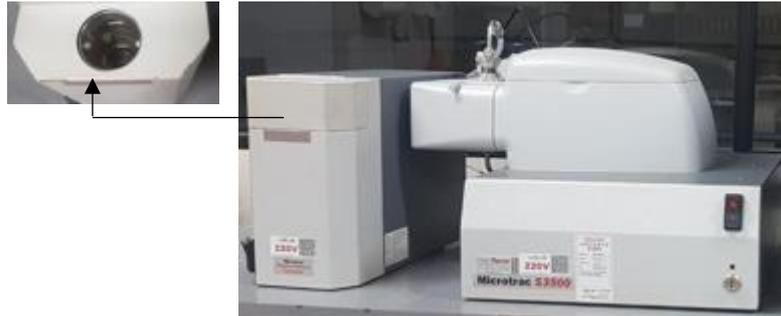
Figura 3.4. Granulômetro por dispersão a laser – detalhe da porta amostra.
