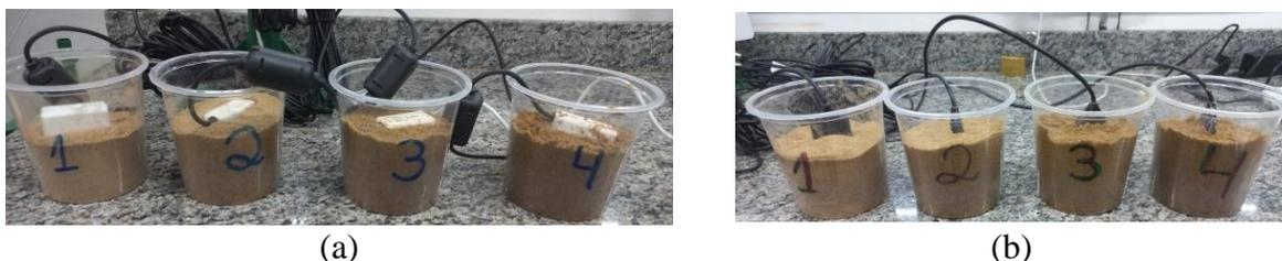
Figura 3.21. Testagem da instrumentação geotécnica. (a) TEROS 10; (b) TEROS 21
