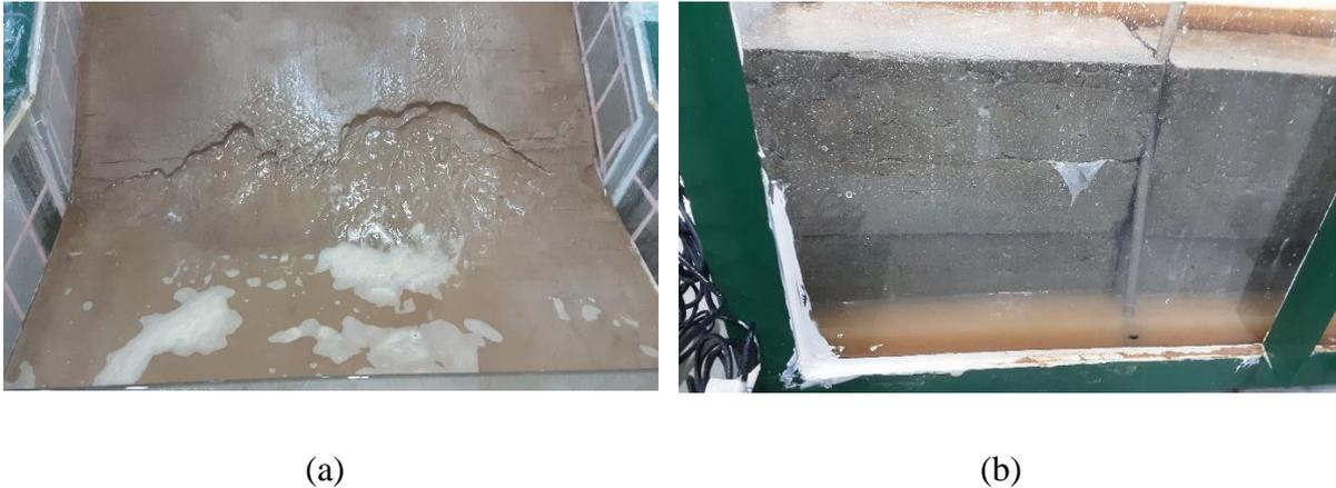
Figura 4.34. Acúmulo de água no equipamento experimental: (a) pé do talude e (b) calha.
