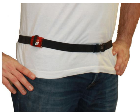
Figura 8. Modelo de acelerômetro e posicionamento na cintura.
