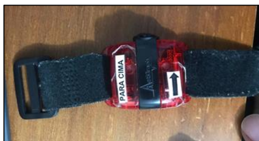
Figura 8. Modelo de acelerômetro e posicionamento na cintura.
