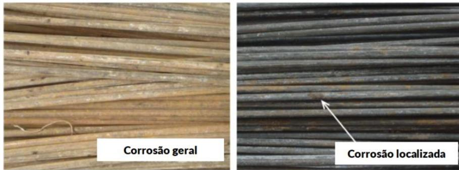
**Figura A.6: Corrosão visível dos cabos - Fonte: Li *et al.* (2014)**
