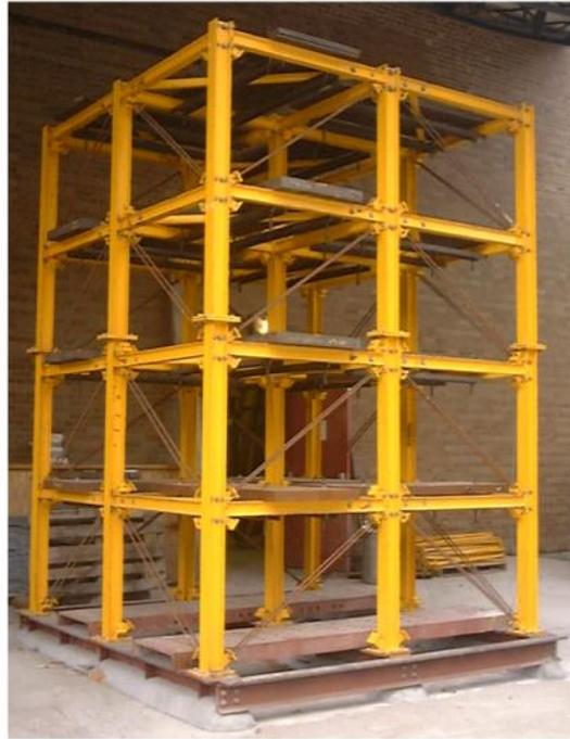
**Figura A.2: Estrutura real do Benchmark Fase I**
