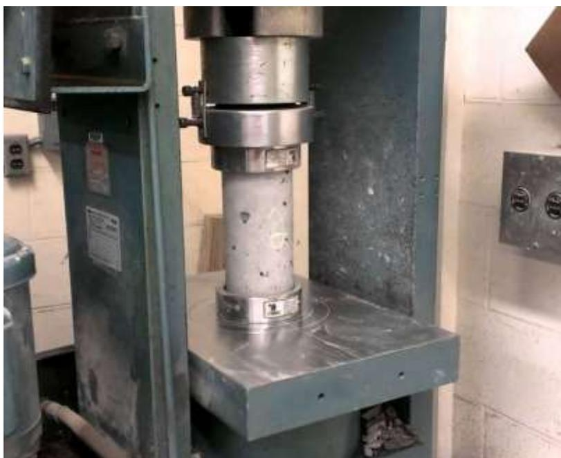
Figura 2.1- Ensaio de resistência à compressão axial do concreto.
