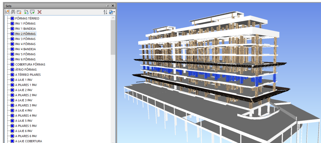
Figura 14: Projeto inserido no Autodesk Navisworks, destacando o grupo de fôrmas de pilares do terceiro pavimento
