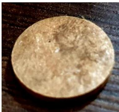
Figura 23 – Aspecto visual da fibra kraft pastilhada com o auxílio de uma prensa hidráulica para o ensaio de espectroscopia de fluorescência de raios-X
