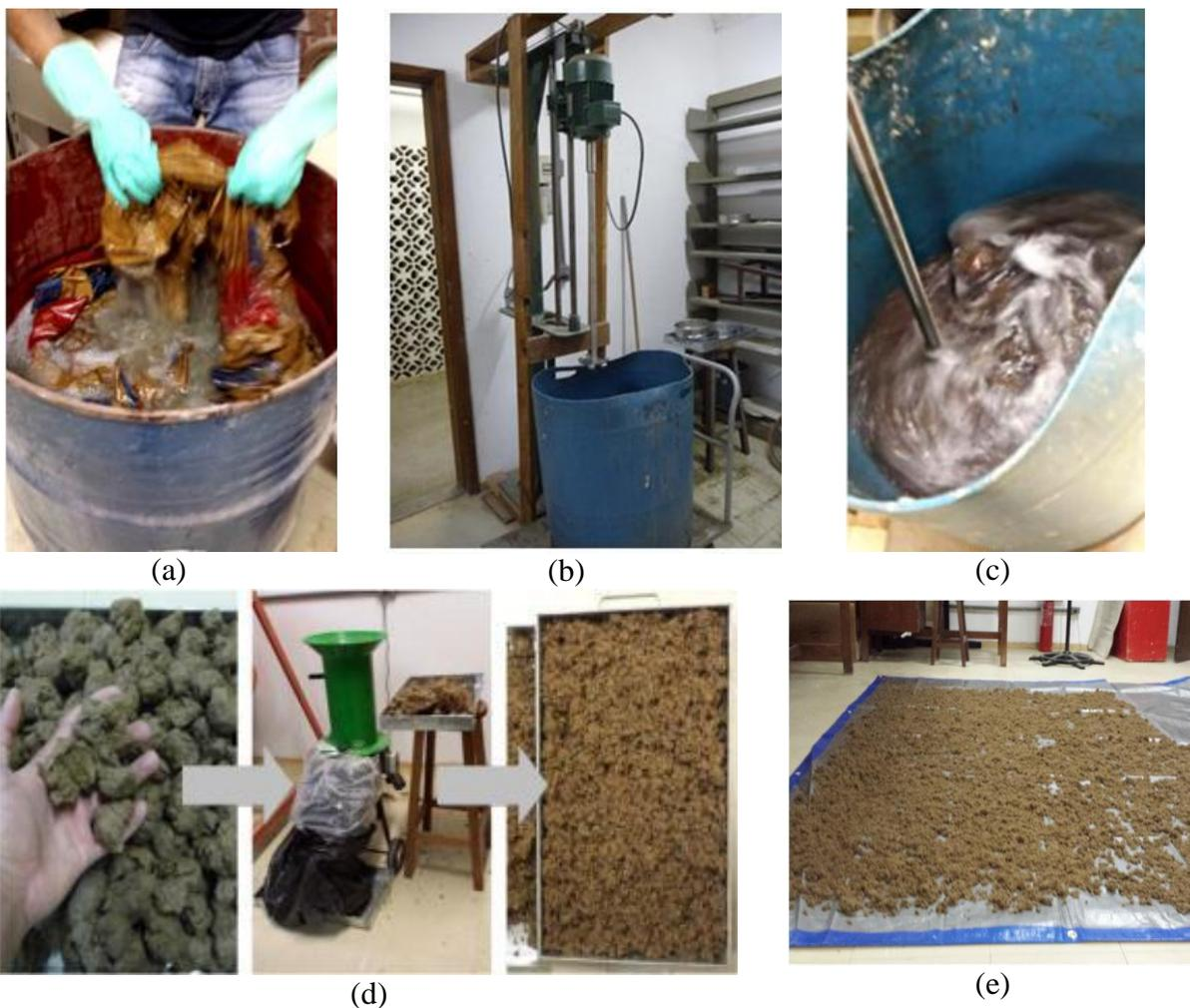
Figura 21 - Processo de lavagem das embalagens para retirada de partículas de cimento (a); Equipamento utilizado na dispersão das fibras kraft (b); Agitação em tanque com água das embalagens para obtenção da polpa celulósica (c); Processo de dispersão das fibras após retirada excesso de água (d); Fibras em processo de secagem para armazenamento (e).
