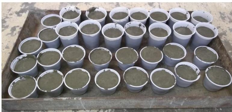
Figura 24 – Amostras pastas sem e com adição de fibras no estado fresco acondicionadas em moldes plásticos.
