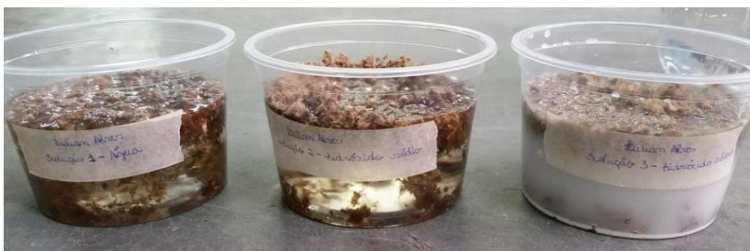
Figura 25 – Imagem das fibras kraft imersas nas soluções preparadas com água deionizada, hidróxido de sódio e hidróxido de cálcio antes de serem fechadas e mantidas até a data de realização do MEV.
