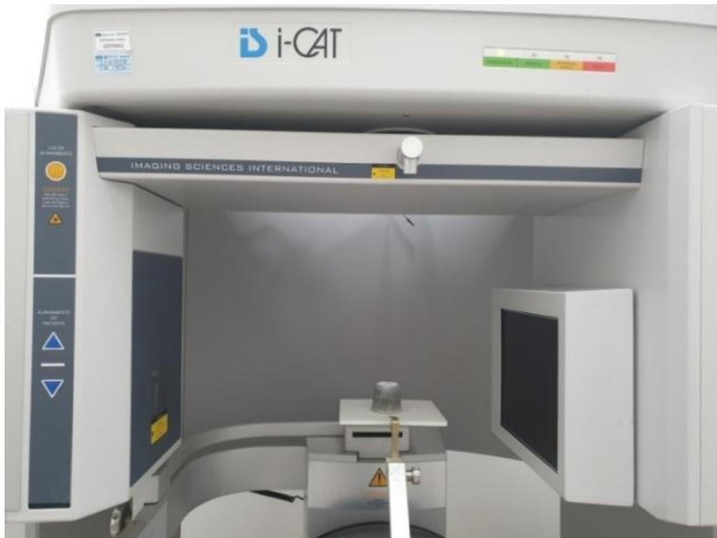
Figura 29 – Corpo de prova posicionado no equipamento de tomografia de marca *I-CAT*, para a realização do ensaio e obtenção das imagens.
