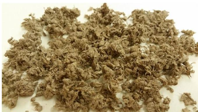
Figura 22 - Aspecto macroscópico da fibra kraft seca armazenada para utilização na produção das pastas.
