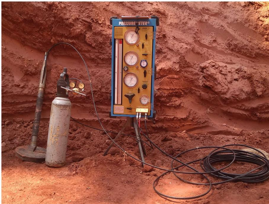
Figura 3.14. Pressiômetro utilizado nos ensaios conduzidos na obra.
