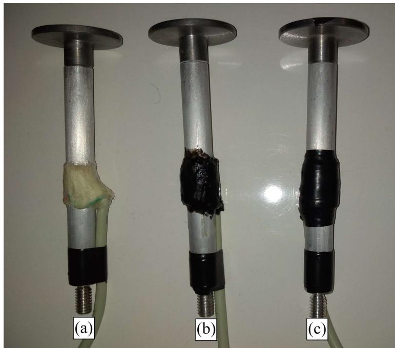
Figura 3.45. Aplicação de cera hidrofugante (a), borracha de silicone (b) e fita isolante (c).
