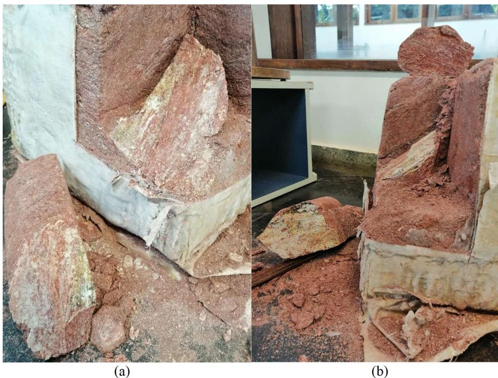
Figura 3.18. Tentativa malsucedida de moldagem de corpo de prova (a) com ruptura provocada por descontinuidade formada pela interposição de camada de quartzo friável (b).
