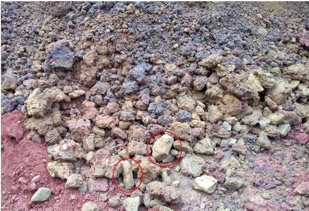
Figura 3.9. Presença de matacões e pedras de mão extraídos durante a perfuração das estacas (fragmentos circulado em vermelho com dimensões entre 20 e 30 cm).
