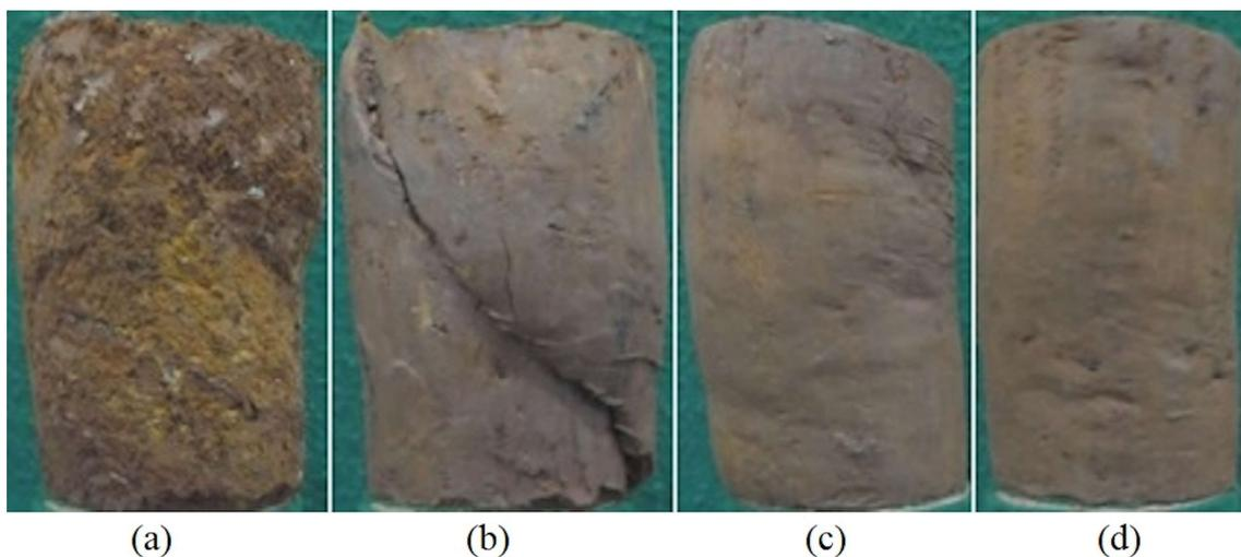
Figura 3.27. Corpos de prova do ensaio CD-3n após a ruptura, para valores de  $\sigma_3$  iguais a 50 kPa (a), 100 kPa (b), 200 kPa (c) e 400 kPa (d).
