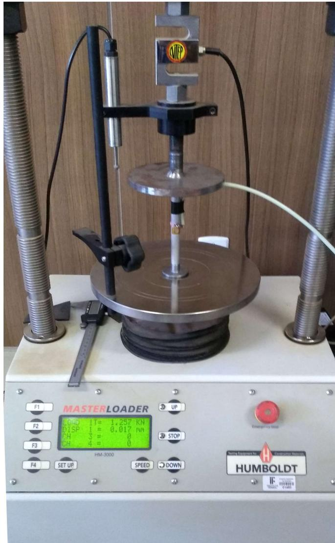
Figura 3.46. Sensor durante processo de calibração.
