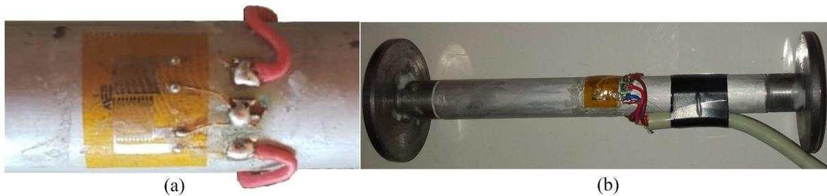
Figura 3.44. Detalhe das montagens dos circuitos primário (a) e secundário (b).
