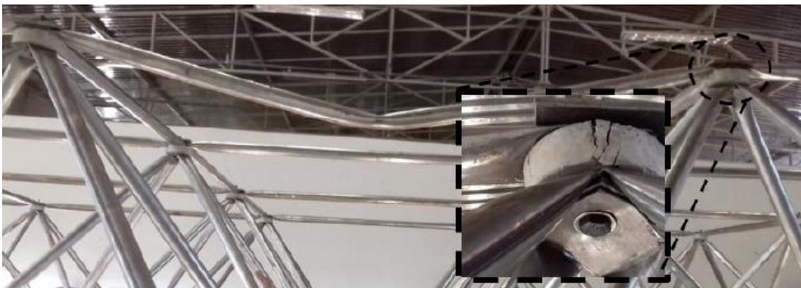
Figura 2.17 – Execução do ensaio experimental de um protótipo de treliça com o uso de espaçadores em concreto com fibra de aço (Silva *et al.*, 2020)
