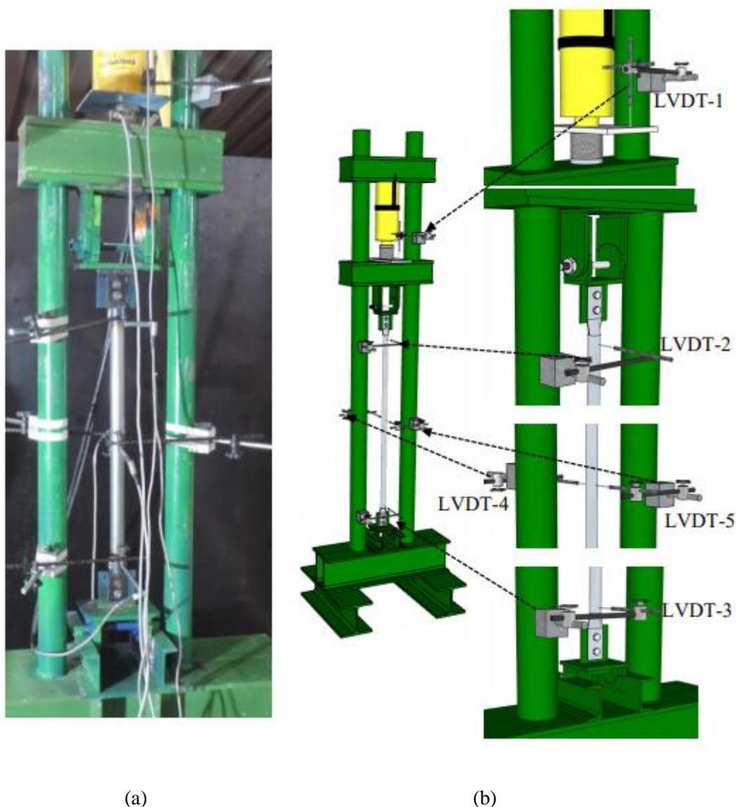
Figura 2.24 – Posicionamento dos LVDTs para a execução dos ensaios: registro da configuração real dos aparatos experimentais (a) e a sua representação gráfica (b) (Silva, 2020)
