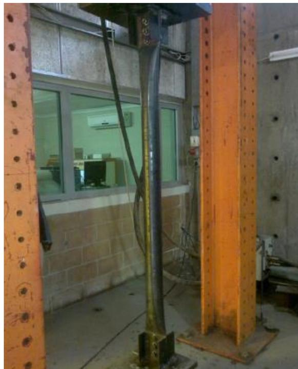
Figura 2.11 – Configuração típica do ensaio de barras isoladas com extremidades estampadas (Dundu, 2014)
