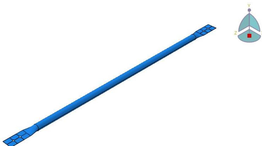
Figura 3.11 – Exemplo de partição dos modelos de barras com extremidades estampadas
