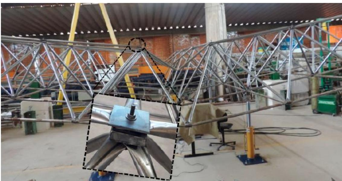
Figura 2.18 – Execução do ensaio experimental de um protótipo de treliça com o uso de espaçadores em concreto encapsulado com fibra de aço (Silva *et al.*, 2020)
