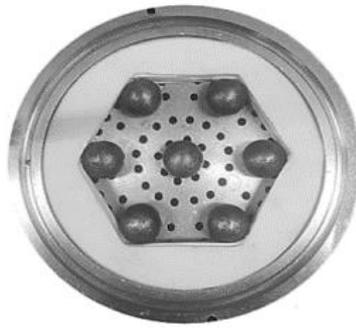
Figura 4.10. Arranjo das esferas de aço com  $s/d = 2$ .
