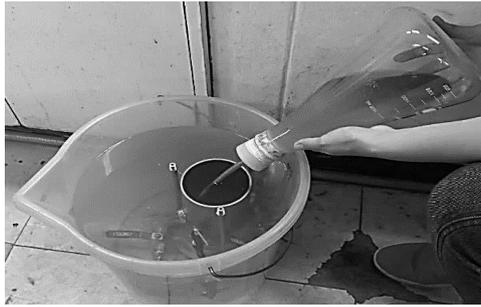
Figura 4.5. Deposição da areia no permeâmetro.
