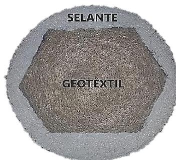
Figura 4.4. Geotêxtil não tecido 200 g/m<sup>2</sup> com selante elástico,  $s/d = 1$ .
