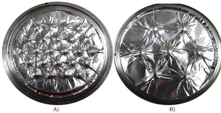
Figura 5.14. Afundamento da folha de alumínio com GNT200 e aplicação de 100 kPa, a)  $s/d = 1$  e b)  $s/d = 2$ .
