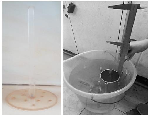
Figura 4.6. Peça de acrílico e medição da altura da amostra com paquímetro.
