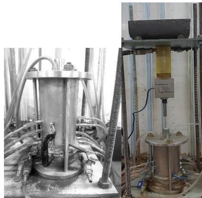
Figura 3.4. Componentes do permeâmetro
