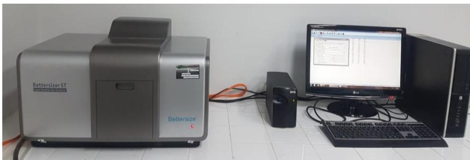
Figura 3.6. Granulômetro a laser.
