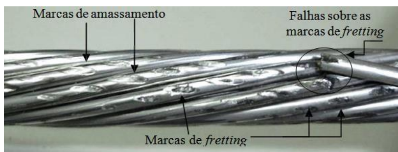
Figura 1.2– Amostra de cabo CAA, evidenciando regiões de contato, desgaste e falhas sobre as marcas de fretting (Fadel, 2010).
