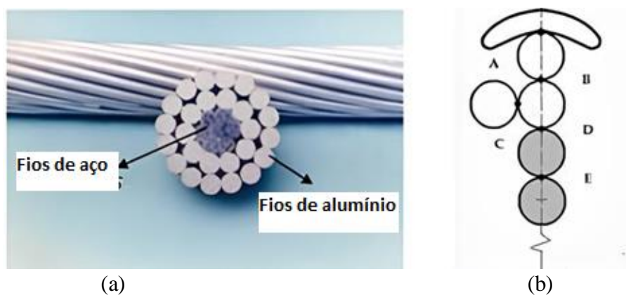
Figura 2.5 – (a) Foto de um cabo condutor CAA em corte, (b) Regiões de contato (Fadel, 2010).
