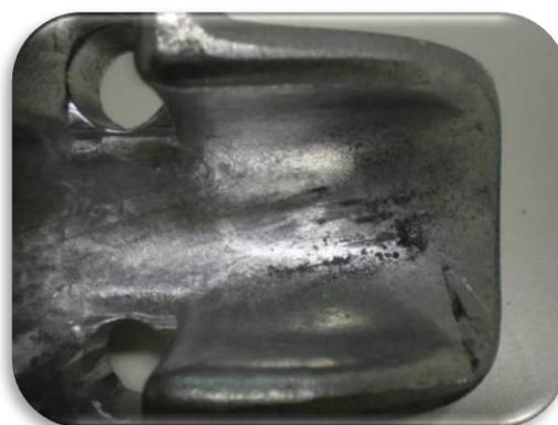
**Figura 4-28** Pó de  $Al_2O_3$  na vizinhança da boca do grampo de suspensão após retirada da amostra (FADEL et al., 2012)
