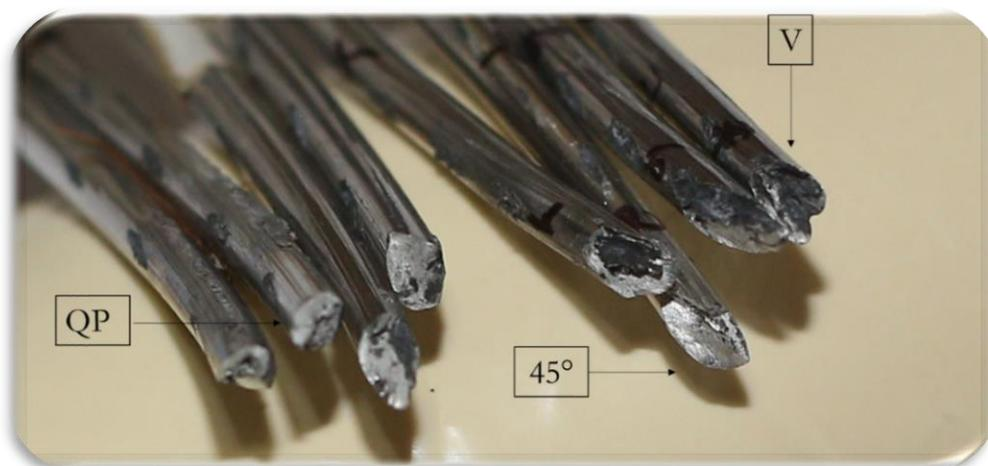
**Figura 4-33 – Frequências das morfologias das falhas EN-10\_A1\_1/3\_75°C**
