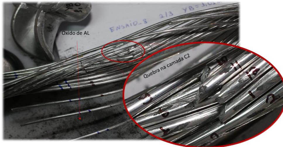
Figura 4-31 – Quantidade excessiva de oxido retirada da EN-08\_A3\_2/3\_75°C e detalhe da quebra na C02
