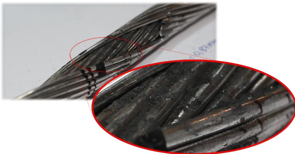
**Figura 4-30 – Quantidade excessiva de oxido na amostra EN-09\_A1\_3/3\_75°C**
