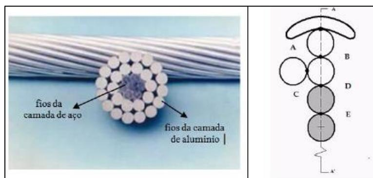
Figura 2-2 – Foto de um cabo condutor ACSR em corte a) e as regiões de contato b), (Fadel, 2010) Adaptado
