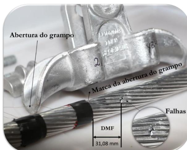
Figura 4-19 – Marca da abertura do grampo, DMF, e falhas no detalhe aumentado
