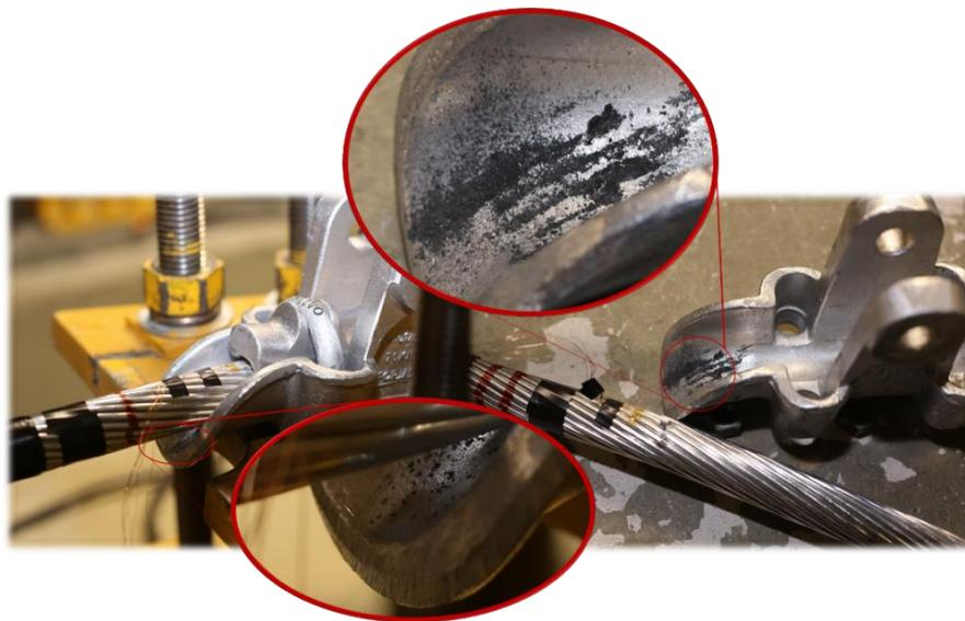
**Figura 4-29 – Pó de Al<sub>2</sub>O<sub>3</sub> no grampo de suspensão durante e após retirada da amostra**
