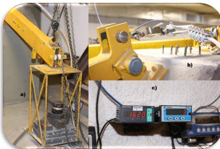
Figura 3-26 – Conjunto de fixação da amostra na outra extremidade
