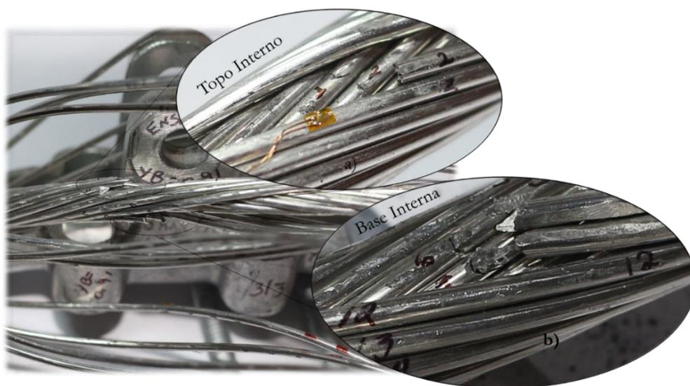
Figura 4-15 – Sistema de numeração dos fios internos de topo interno a) e base interna b)
