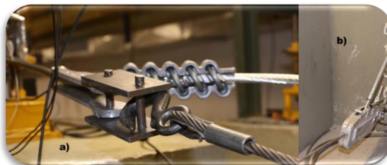
Figura 3-25 – Conjunto de ancoragem do cabo em uma extremidade
