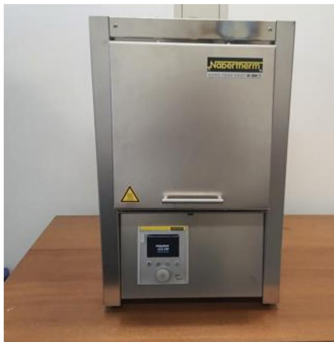
**Figura 20**- Forno Nabertherm P 310.
