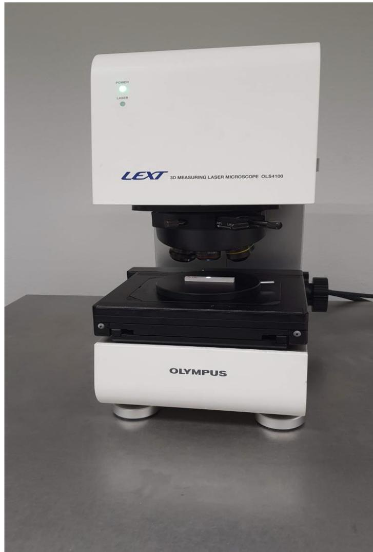
**Figura 28** - Microscópio confocal a laser Olympus LEXT OLS4100 (FT- ENM -UnB).
