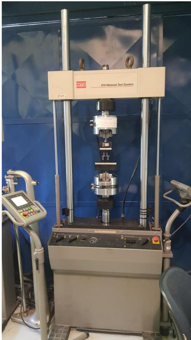
**Figura 31** - Montagem do ensaio de resistência à flexão em quatro pontos- MTS 810.
