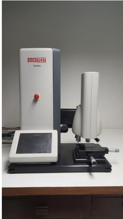
**Figura 25** - Microdurômetro Emco Test DuraScan 20 – FT-ENM-UNB.
