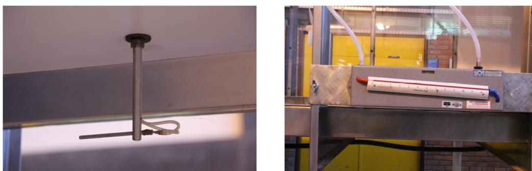
Figura 3.16 – Tubo de pitot (Esquerda) e manômetro de coluna inclinada (Direita)
