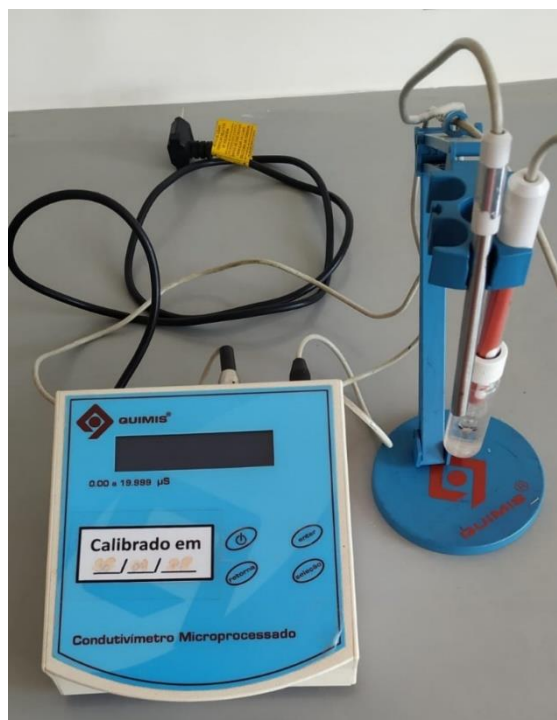
Figura 4. Condutivímetro de bancada para teste de condutividade elétrica das sementes de Tabebuia serratifolia . Fonte: Acervo pessoal.
