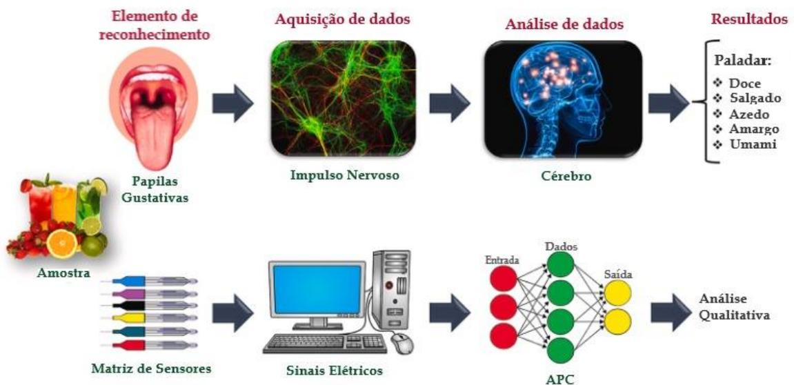
**Figura 3.** Ilustração esquemática de um sistema multissensorial tipo língua eletrônica comparado ao sistema gustativo biológico.
