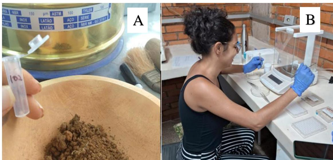
Figura 1.3: Processo de preparação das amostras para a análise de C-org. Amostra antes de ser triturada e passada pela peneira (A), e pesagem de 1,0 mg da amostra e encapsulamento com pinças (B).
