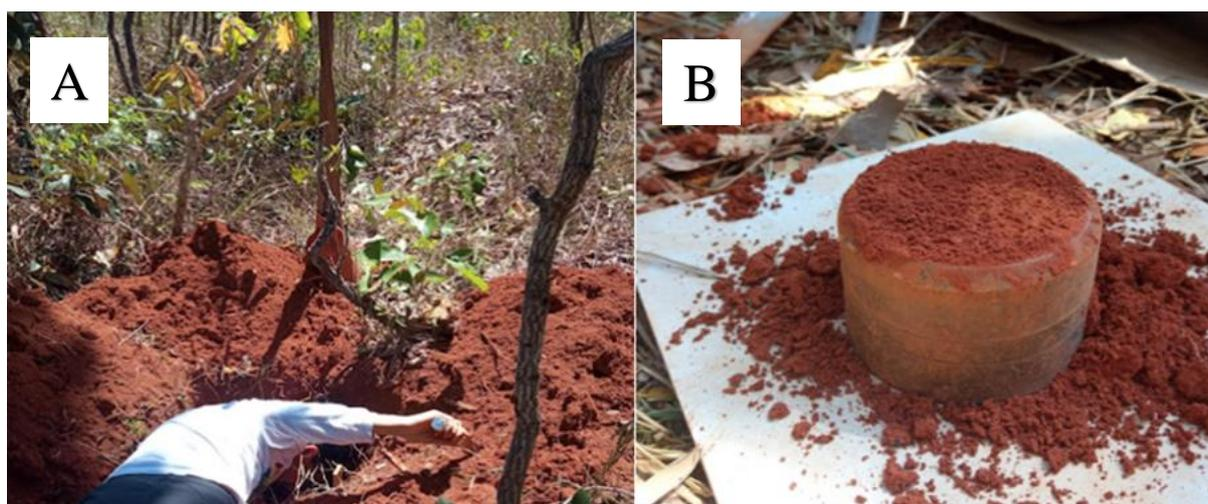
Figura 1.2: Coleta de solos. Retirada das amostras de solo dentro da trincheira com os anéis volumétricos (A), e amostra indeformada logo após ser retirada do solo (B).
