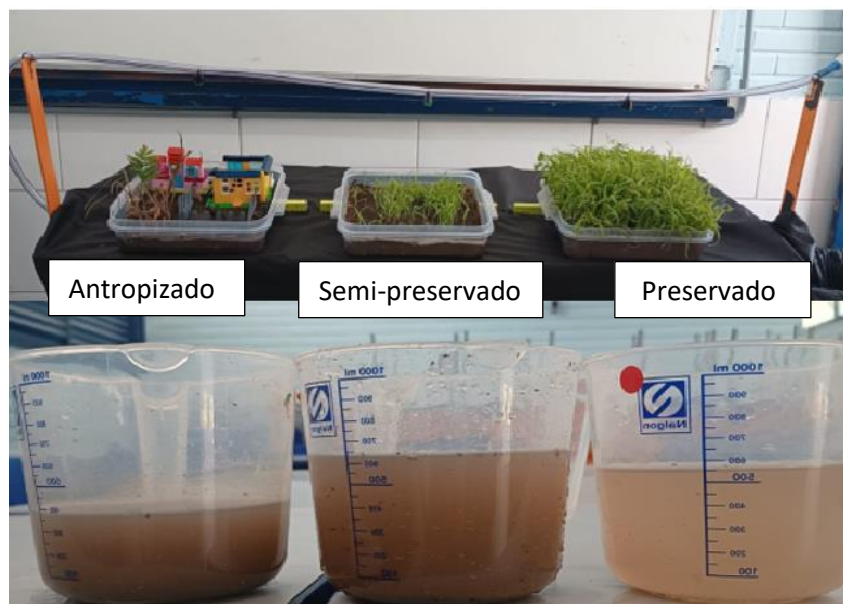
Figura 5- Protótipo de ensino montado e seus respectivos resultados de drenagem
