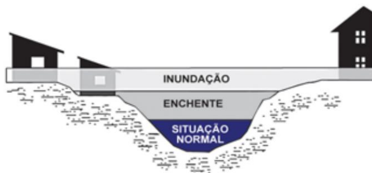
Figura 3 - Esquema exemplificando a diferença entre enchente e inundação.
