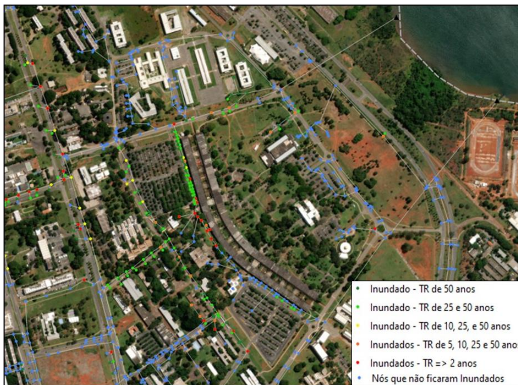
Figura 87 – Localização dos nós que ficaram inundados no campus da Universidade de Brasília – UNB, na Asa Norte/Plano Piloto – DF.
