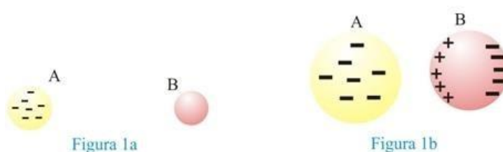
Figura 5.2 – Processo de eletrização: indução
