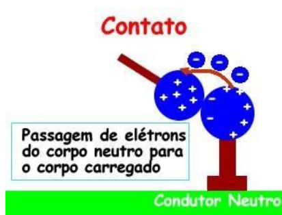
Figura 5.3 – Processo de eletrização: contato
