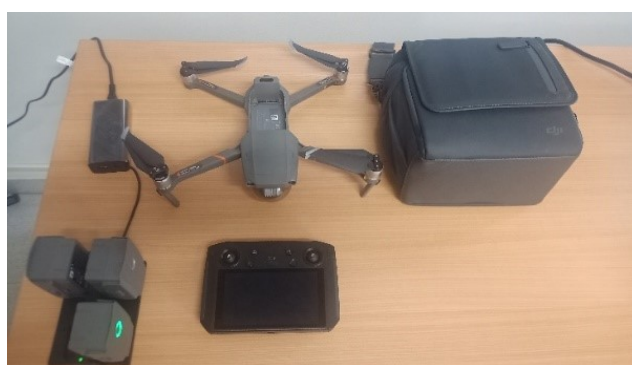
Figura 3.11: Componentes Táticos do drone Mavic 2 Enterprise [74]
