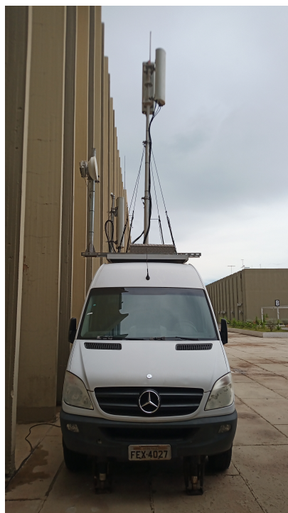
Figura 3.14: Sistema 5G Tático EB – Visão frontal [74]
