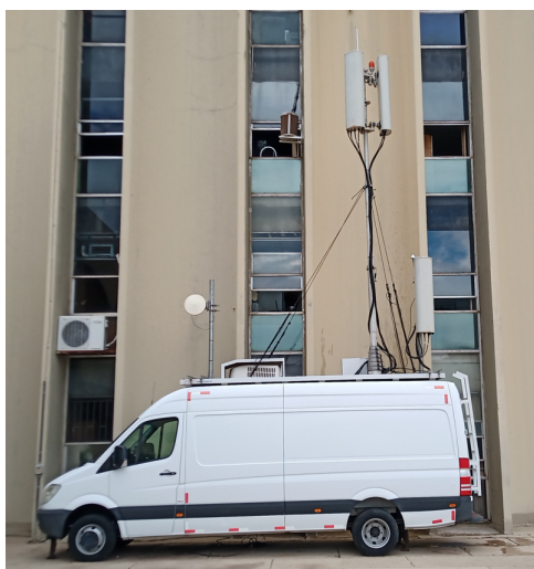
Figura 3.13: Sistema 5G Tático EB – Visão lateral [74]
