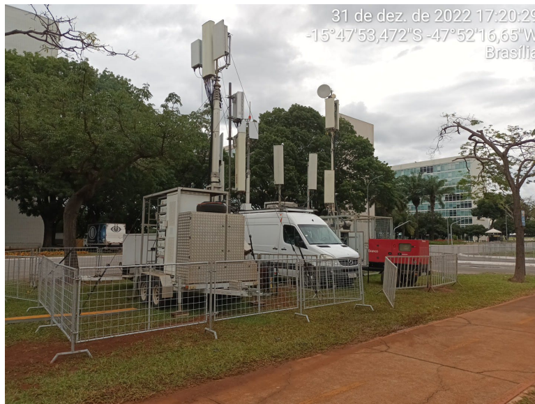
Figura 4.31: Sistema 5G Tático EB 1 na região Oeste da Esplanada dos Ministérios no dia 1º JAN 23 [149]
