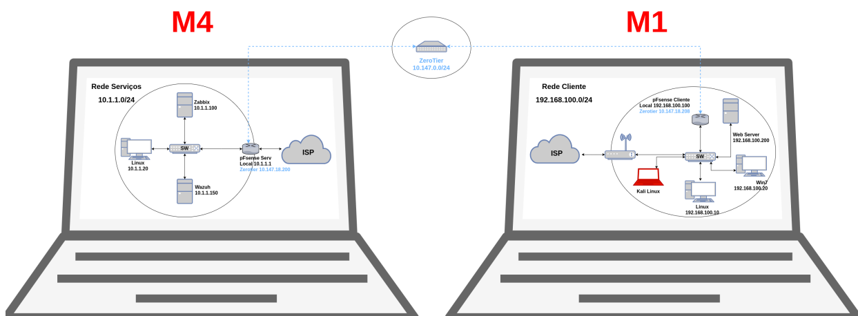
Figura 4.34: Cenário 4 Topologia - 2 redes virtuais em 2 máquinas físicas diferentes.
