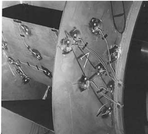
Figura 1.2 - Strain gage instalado em turbina.
