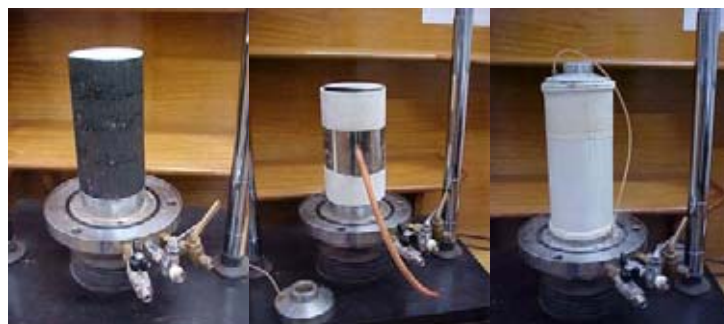
Figura 3.14 - Procedimento de colocação da membrana impermeável.
