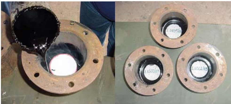
Figura 3.20 - Adição da mistura selante aos corpos de prova dentro das campânulas.
