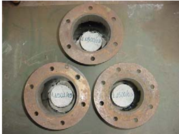
Figura 3.19 - Corpos de prova dentro da campânula aguardando a colocação de material selante.
