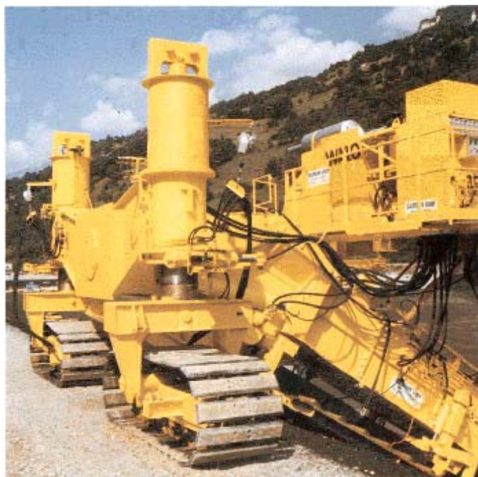
Figura 2.4 - Sistema locomotor da pavimentadora horizontal (Walo, 1997b).
