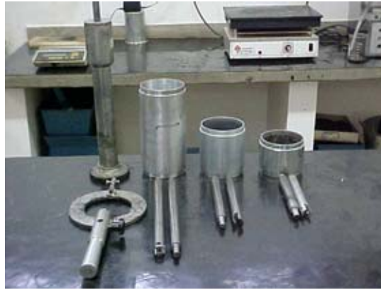
Figura 3.5 - Cilindros metálicos e respectivos conjuntos de fixação.
