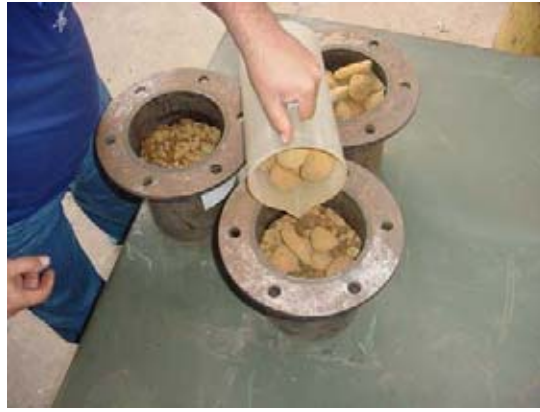
Figura 3.21 - Adição da camada de cascalho sobre os corpos de prova.
