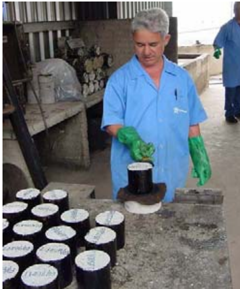
Figura 3.18 - Aplicação da pintura de ligação de neutrol na lateral do CP.
