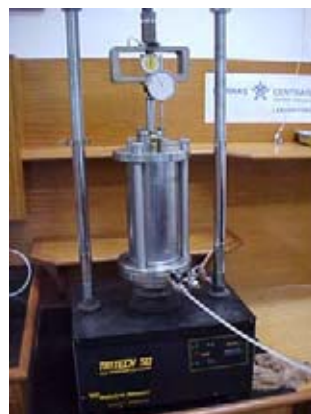
Figura 3.15 - Prensa triaxial montada e pronta para o início do ensaio.
