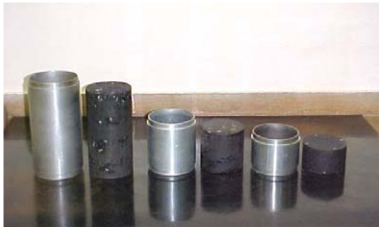
Figura 3.7 - Corpos de prova extraídos após a compactação.
