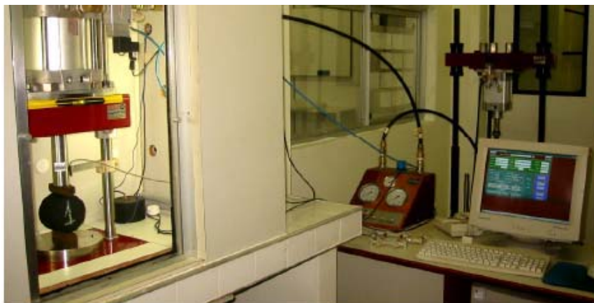
Figura 3.10. Prensa pneumática para execução de ensaios de MR.
