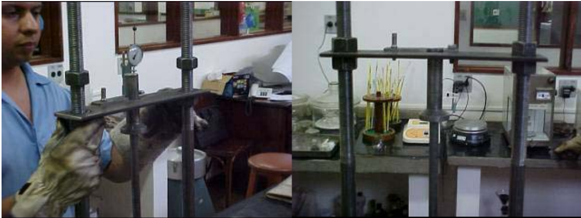
Figura 3.6 - Procedimento de ajuste da trava metálica.
