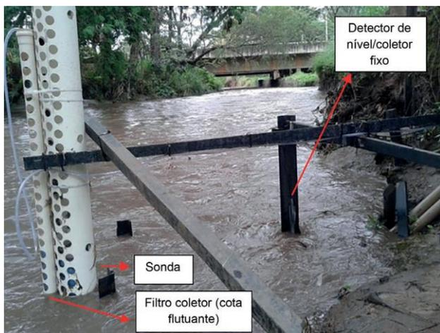
**Figura 4.** Estrutura para sonda e amostragem de sedimento com variação da cota e lance de réguas em funcionamento.
