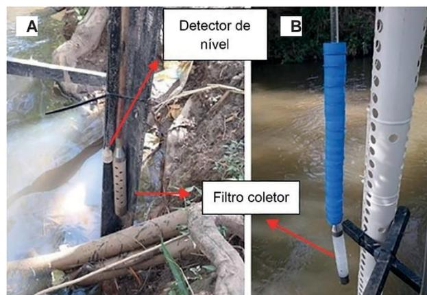
**Figura 3.** (A) Amostragem fixa de água e sedimentos. (B) Adaptação para flutuabilidade do filtro coletor a 40 cm de profundidade em relação à superfície da água.
