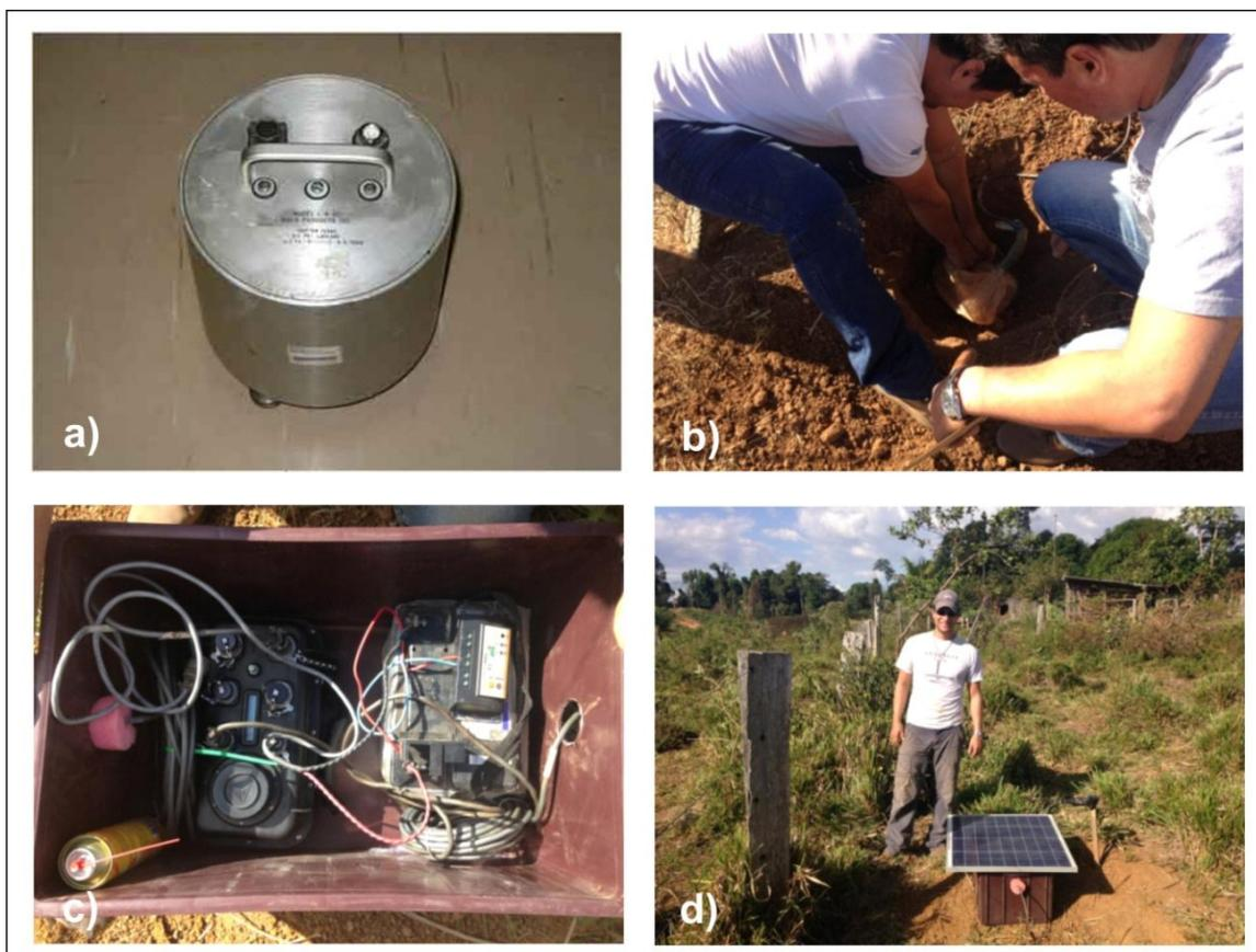
**Figura 10:** Equipamentos e procedimentos de campo para instalar estações triaxiais de período curto. em a) Sensor L4A 3 componentes, modelo Sercel; em b) sensor sendo instalado no campo; em c) dispositivos da estação, compostos por bateria, registrador e GPS; em d) exemplo de estação triaxial montada, alimentada por uma placa solar.
