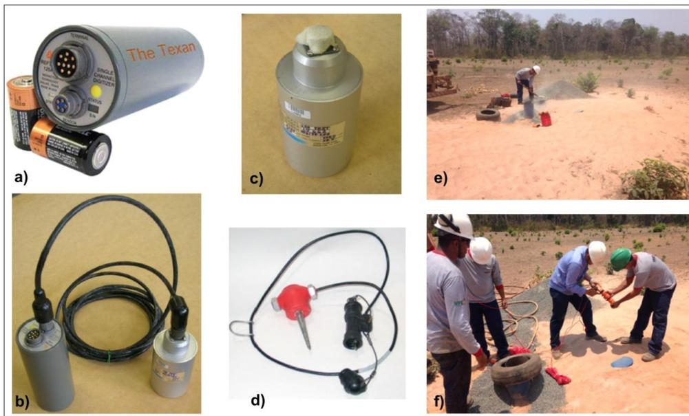
**Figura 6:** Equipamentos e procedimentos de campo do método da sísmica de refração profunda. em a) registrador do pool brasileiro Texan; em b) sensor e registrador acoplados; em c) sensor triaxial da PASSCAL; em d) geofone da PASSCAL; em e) tamponamento do poço com brita; em f) preparação da espoleta para detonação durante a madrugada.
