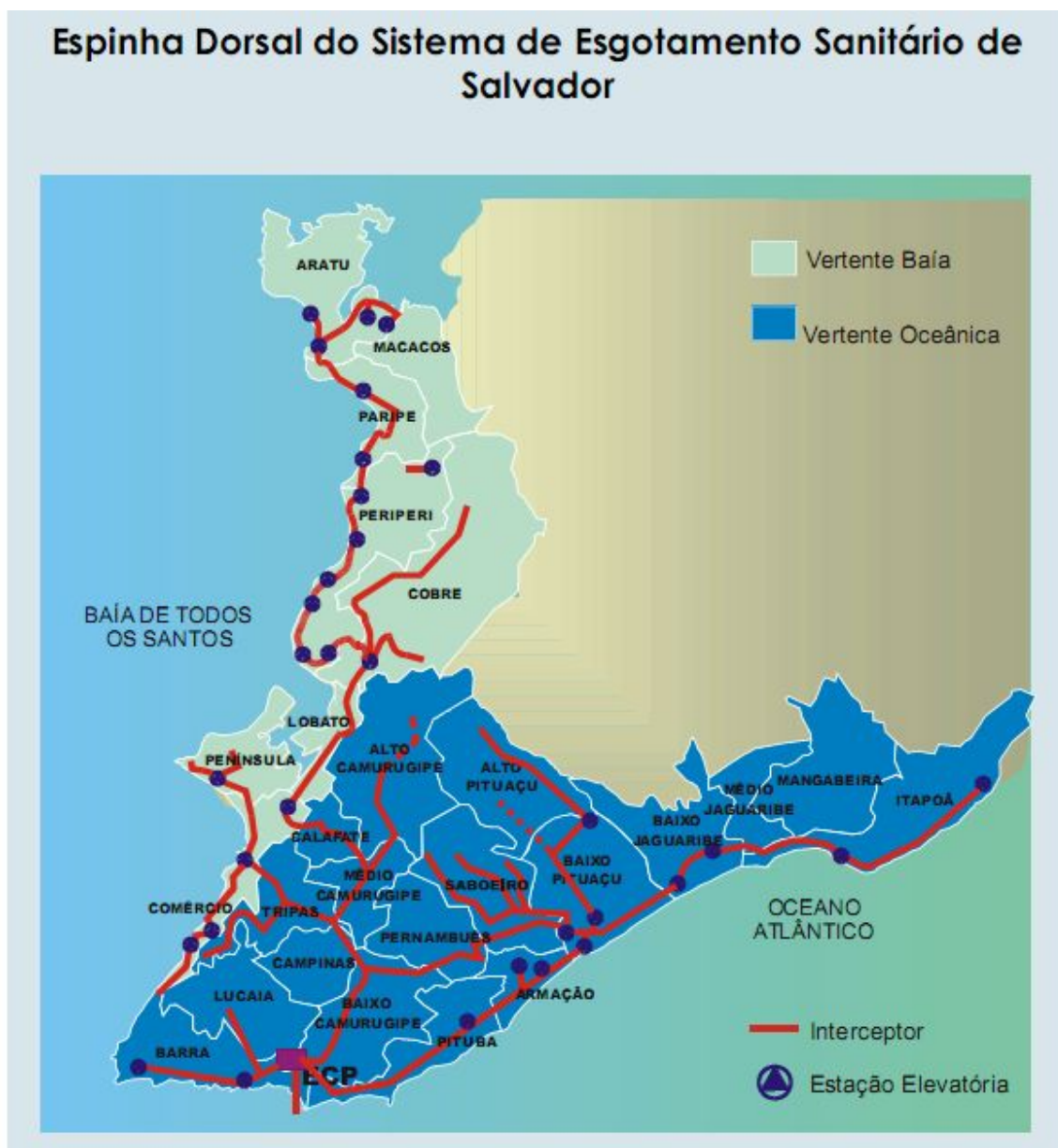
Figura 2.5.4 – Desenho esquemático do Sistema de Esgotamento Sanitário de Salvador, mostrando as bacias de esgotamento. A ampliação do sistema elevou a cobertura de atendimento de 26% para 76% em doze anos.
