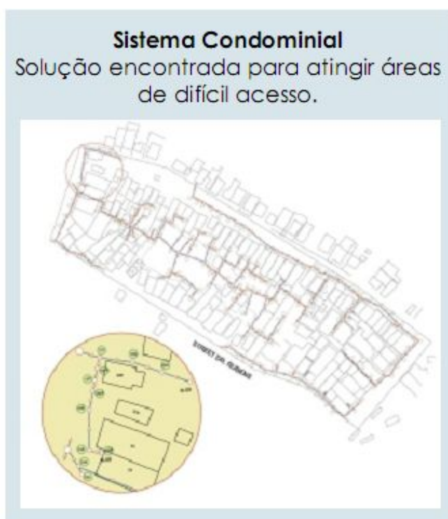
Figura 2.5.3 Desenho esquemático e detalhe de um sistema condominial de esgotos. Fonte: Relatório de Trechos Críticos. Embasa, 2006.
