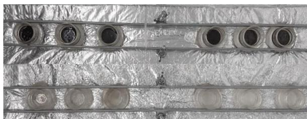
Figura 3.3 Imagem das amostras dispostas nos suportes para a realização do experimento de permeação *in vitro* utilizando o método Saarbrücken modificado. Ilustração da Autora.
