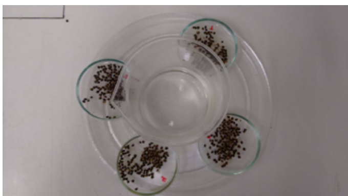
Figura 5: Disposição das placas de Petri e do béquer com água destilada centro do prato do aparelho micro-ondas
