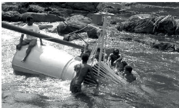
Figura 2.4: turbina geração 2 produzida pela Universidade de Brasília com potência nominal de 2 kW [2].
