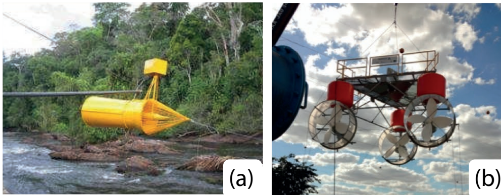
Figura 2.2: modelos de referência para análise. Turbina Geração 2 de 2kW em (a) e plataforma Hydro-K de 30kW em (b).
