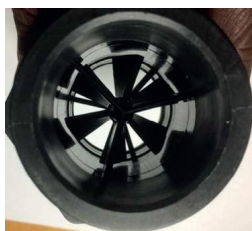
Figura 4.26: Foto do sensor utilizado para medir velocidade. Dimensões: 92 x 59mm (L x diâmetro).
