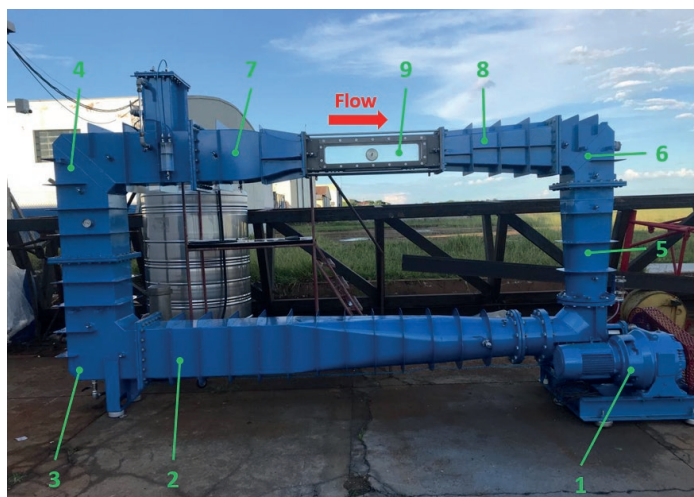
Figura 9.57: Túnel de água recondicionado.
