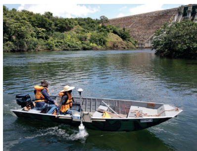
Figura 4.10: ADCP instalada na embarcação para realização de medições in situ .
