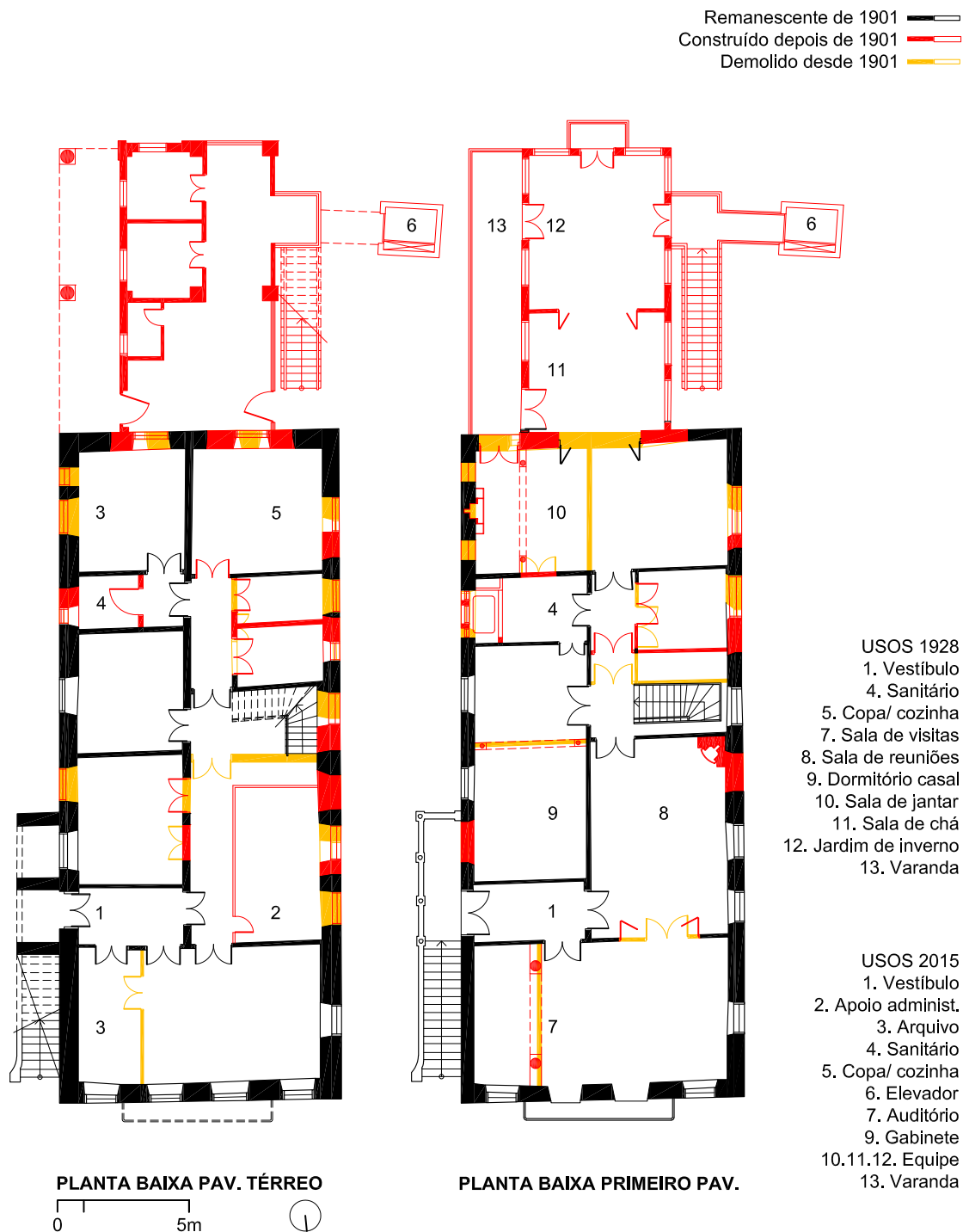
Figura 7.89. Planta-síntese das transformações sofridas pelo Palacete Argentina de 1901 até o presente, indicando os usos de 1928 e 2015. É possível observar as transformações de 1928 e aquelas posteriores a 1984, com a implantação da sede local do Iphan. O desenho resulta da sobreposição dos registros de 1901, 1928, 1984 e 2015. 175
