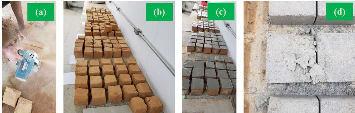
Figura 38 - (a) Processo de corte dos prismas; (b) prismas cortados; (c) prismas cortados e capeados; (d) adobes com 100% de resíduo inviabilizados para ensaio de resistência à compressão
