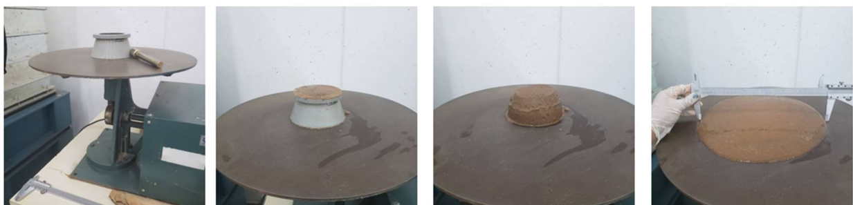
Figura 28 – Ensaio de consistência
