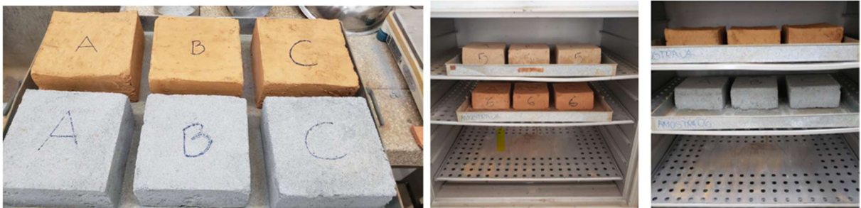
Figura 34 - Corpos de prova submetidos à estufa para a realização do ensaio de absorção de água
