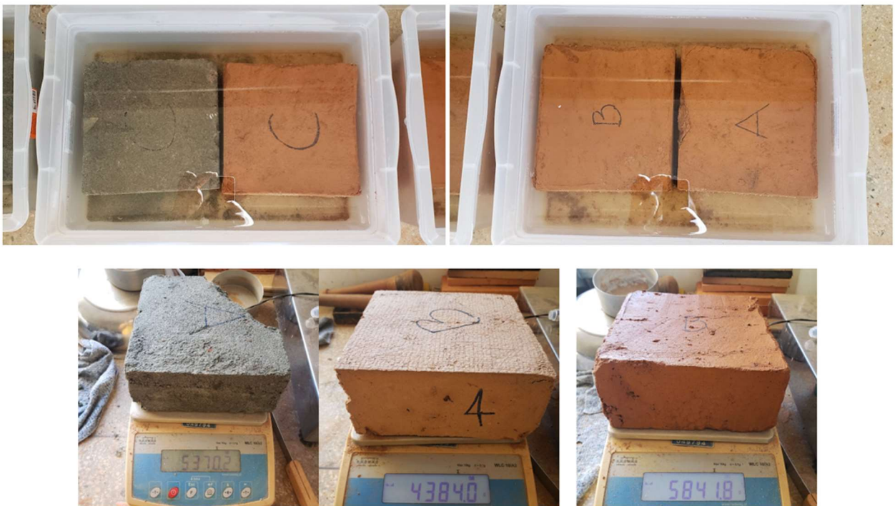
Figura 35 - Corpos de prova (CP) submetidos ao ensaio de absorção de água
