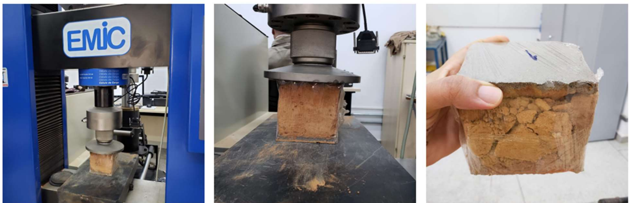
Figura 39 - Ensaio de compressão
