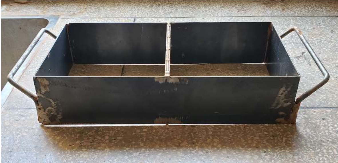
Figura 24 - Forma metálica para a produção dos adobes (9 cm x 19 cm x 19 cm)
