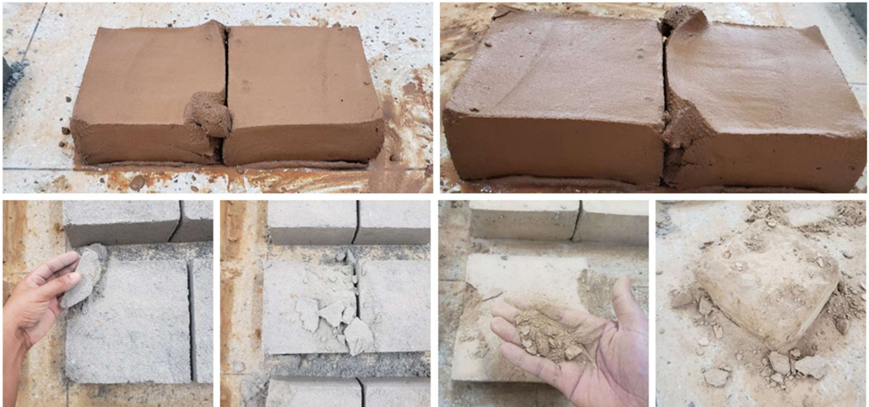
Figura 33 - Dificuldades verificadas no processo de produção dos adobes em diferentes proporções de incorporação do resíduo
