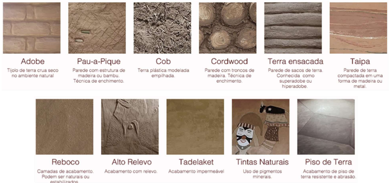
Figura 15 - Técnicas de construção com terra e suas aplicações mais comuns no Brasil
