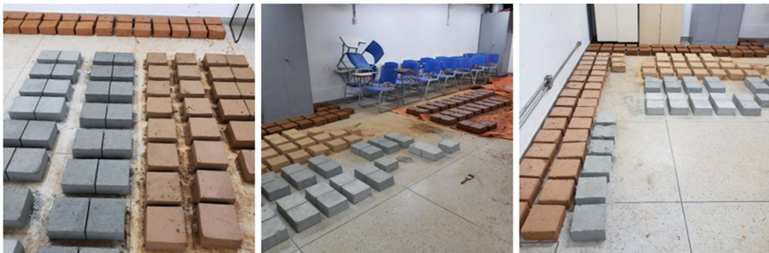
Figura 26 - Moldagem dos adobes
