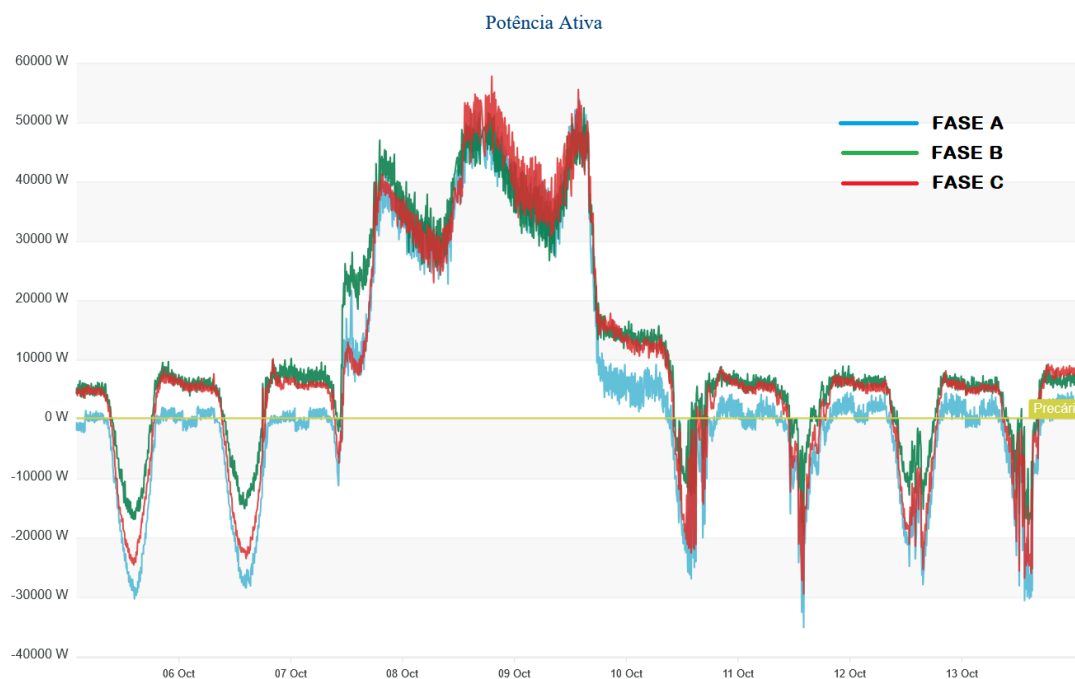
Figura 6.2. Perfil da curva de Potência Ativa nas fases da entrada de energia elétrica da subestação da FT/UnB.
