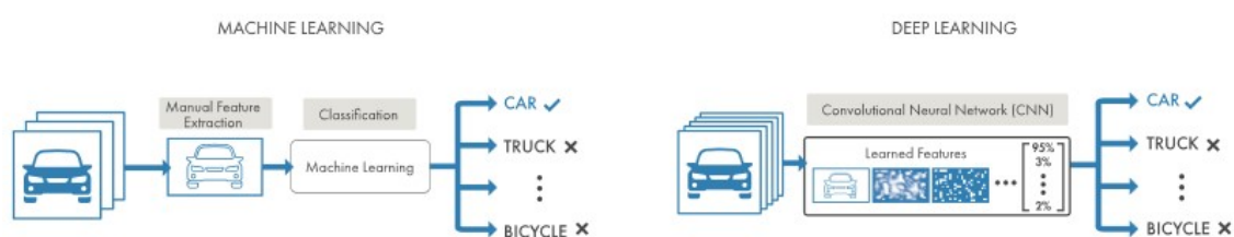
Figura 40 - Diferença entre o processo de classificação de imagens realizado por aprendizado de máquina e por aprendizado de máquina profundo
