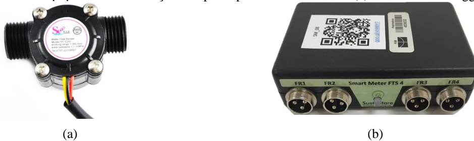
Figura 8 – Equipamento de medição composto por medidor de fluxo (a) e módulo data logger (b)
