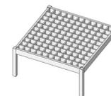
**Figura 6** - Sistema Básico. Subsídios para o projeto. Esquema das malhas com independência entre módulos, resultando em quatro pilares com vazios para instalações.
