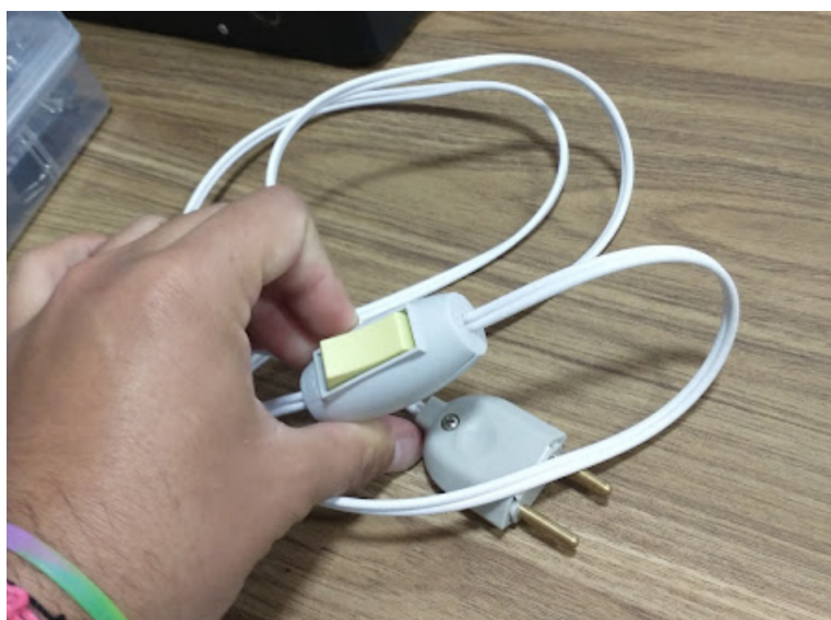
Figura 0.7: Detalhe da Bancada Didática: o interruptor na alimentação da lâmpada Fonte: próprio autor.
