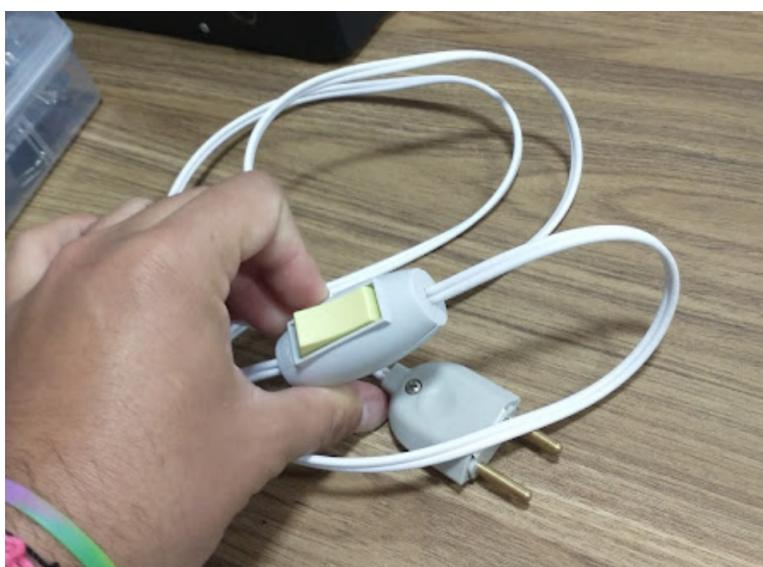
*Figura C.7: Detalhe da Bancada Didática: o interruptor na alimentação da lâmpada Fonte: próprio autor.*
