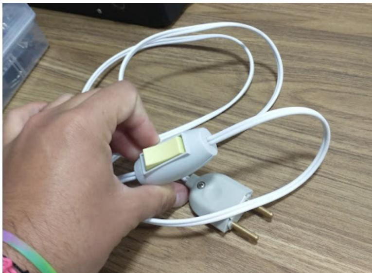
Figura 4.5: Detalhe da Bancada Didática: o interruptor na alimentação da lâmpada Fonte: próprio autor.
