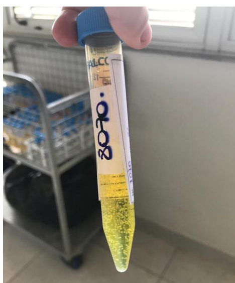
Figura 12. Amostra de cabelo após a digestão, amarela pelo ácido nitroso produzido. Fonte: Elaboração própria
