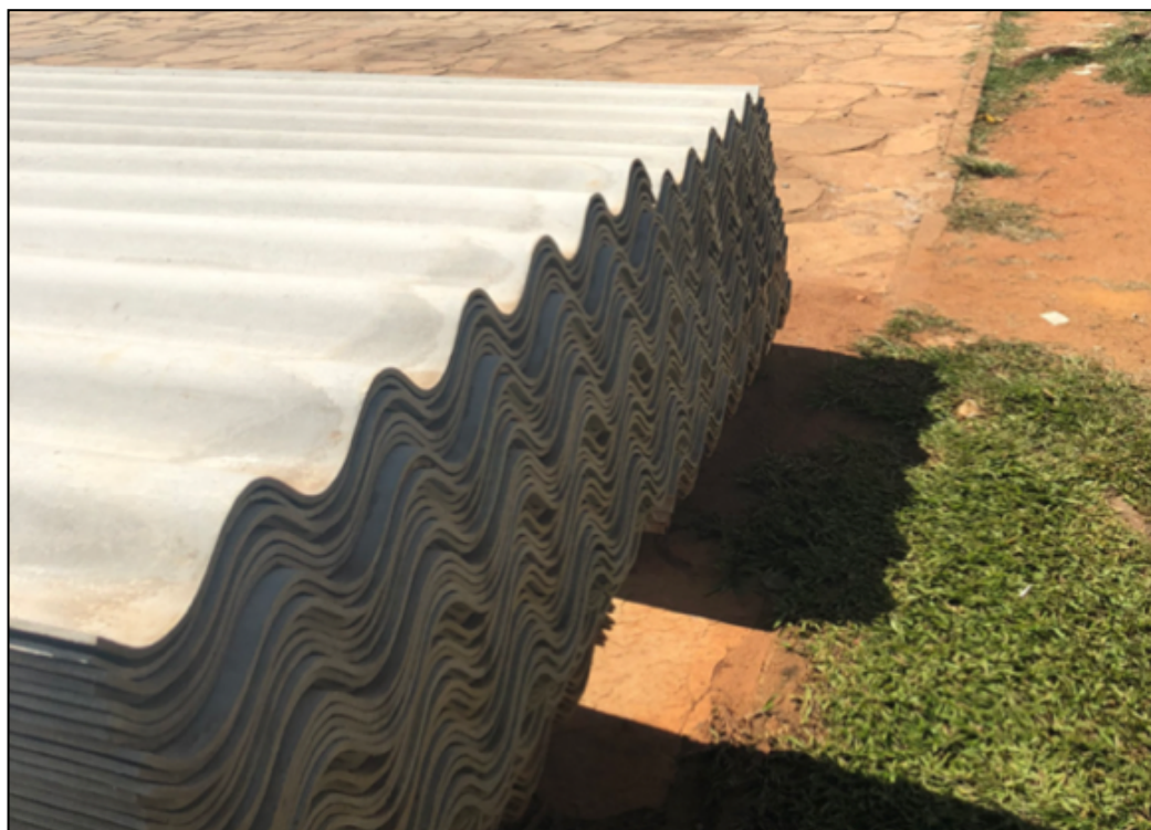
Figura 10 - Telhas de cimento-amianto
