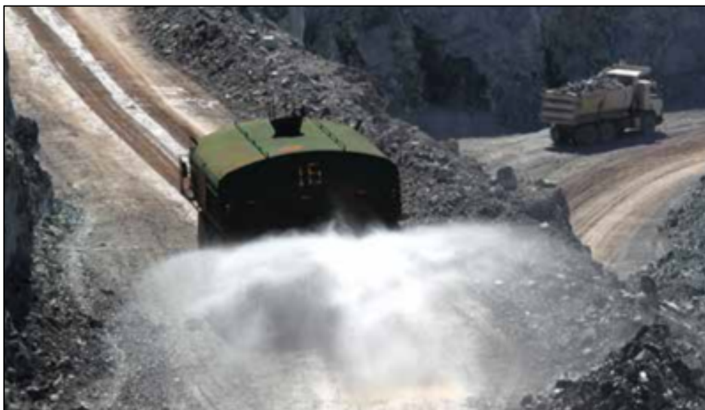
Figura 31 – Umidificação de taludes da mina Cana Brava
