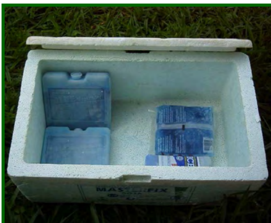
Figura 1.6 – Caixa de isopor contendo bolsas térmicas de gelo sintético utilizadas no armazenamento e transporte das amostras.
