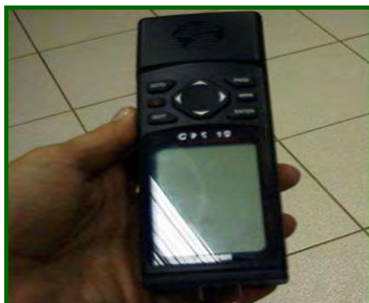
Figura 1.7 – GPS (Global Positioning System) marca Garmin modelo 12 utilizado na determinação das coordenadas geodésicas
