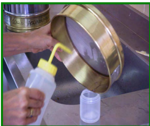
Figura 1.10 - Método de lavagem utilizado para extração de ácaros - transferência de partículas retidas na peneira de menor abertura para pote plástico utilizado no armazenamento das amostras em álcool etílico a 70%
