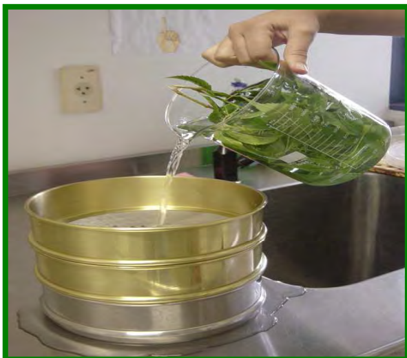
Figura 1.8 - Método de lavagem utilizado para extração de ácaros - peneiramento após a submersão do material vegetal em solução com detergente
