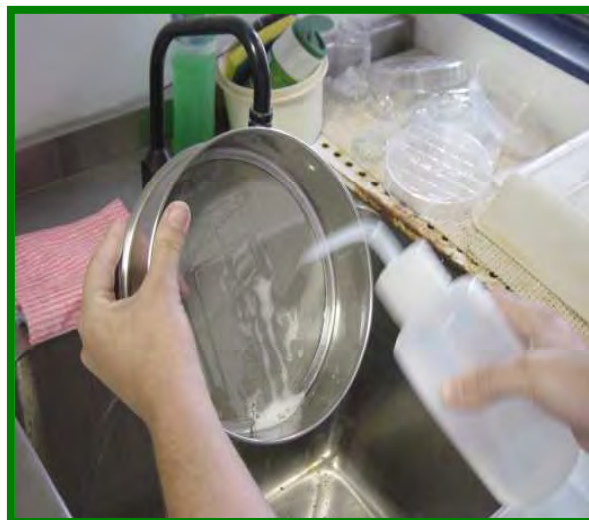
Figura 1.9 - Método de lavagem utilizado para extração de ácaros - lavagem da peneira de menor abertura com jato de álcool 70%
