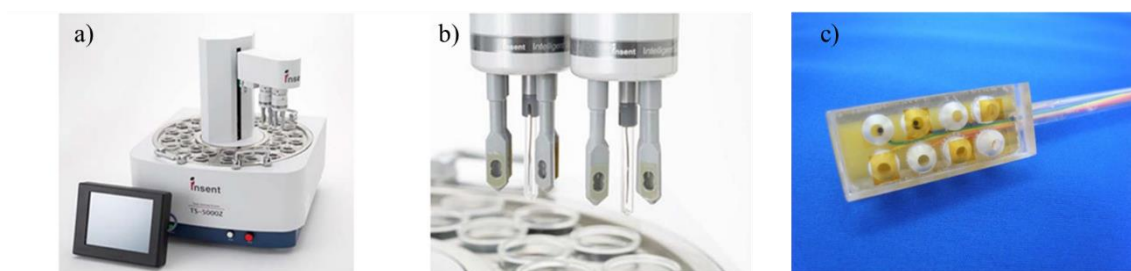
Figura 9 – Fotografia do a) Sensor de sabor TS-5000Z, b) membranas sensoras lipídio/polímero e c) sonda multicanal desenvolvida nos anos de 1980 54 .
