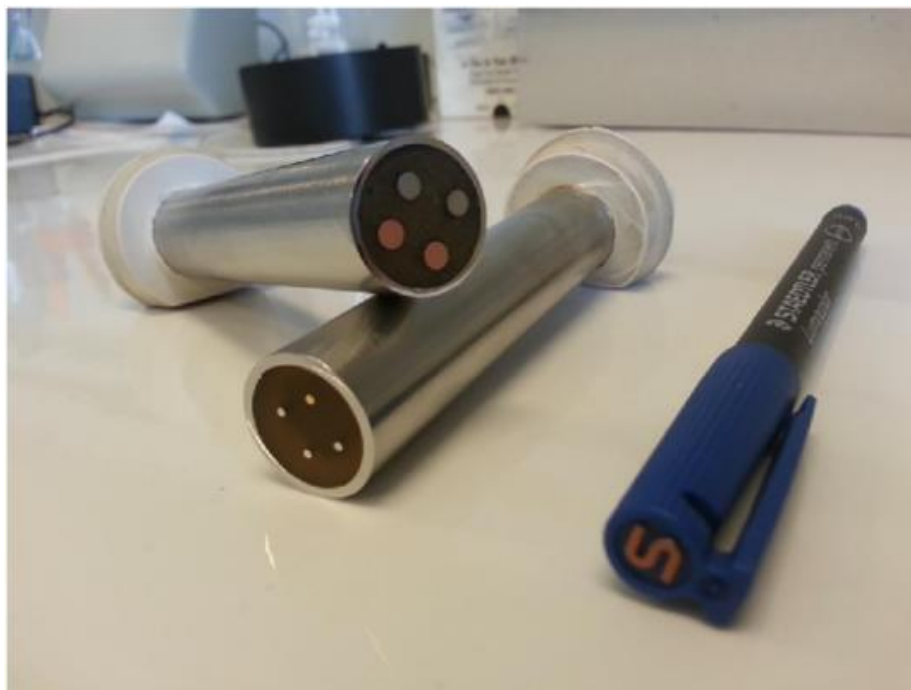
Figura 11 – Fotografia dos eletrodos metálicos encapsulados em cilindros de aço-inoxidável e uma caneta para critérios de comparação de tamanho 69 .
