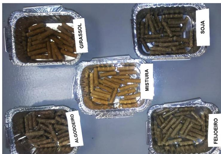
Figura 22. Pellets não torrados: de Algodoeiro (100%), Girassol (100%), Feijoeiro (100%), Soja (100%) e Mistura (50% de maravalha de Pinus e 50% de Girassol).
