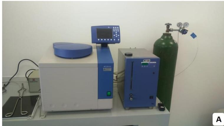
Figura 8. Determinação do poder calorífico. A) Bomba calorimétrica.
