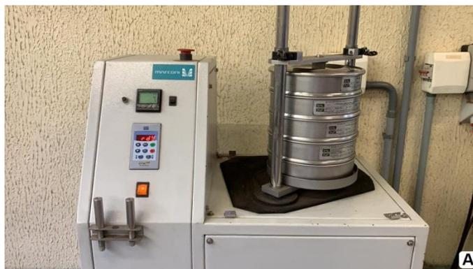
Figura 4. Classificação Granulométrica. A) Agitador eletro-magnético de peneiras.
