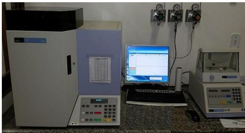
Figura 7. Analisador elementar CHNS Perkin Elmer modelo EA 2400. Fonte: [www.caiq.unb.br](http://www.caiq.unb.br)
