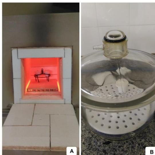
Figura 5. Sequência para obtenção de dados para a determinação do teor de materiais voláteis: A) amostras no interior da mufla. B) amostras no dessecador.
