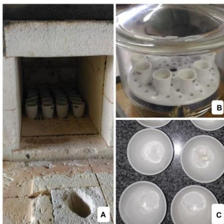
Figura 6. Sequência para obtenção de dados para a determinação do teor de cinzas: A) amostras inseridas na Mufla. B) amostras em dessecador após ensaio. C) cinzas de biomassa de Girassol.
