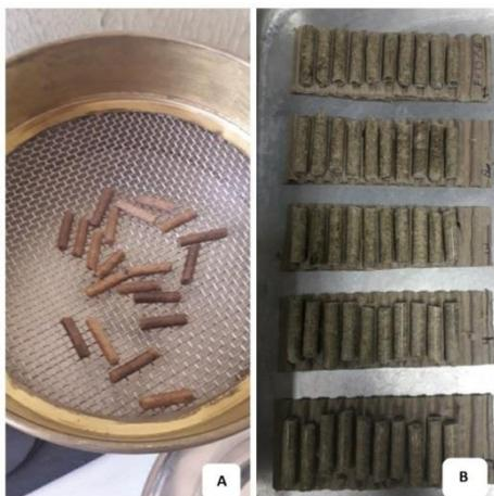
Figura 16. Caracterização dos pellets: A) determinação da durabilidade. B) determinação da densidade aparente.
