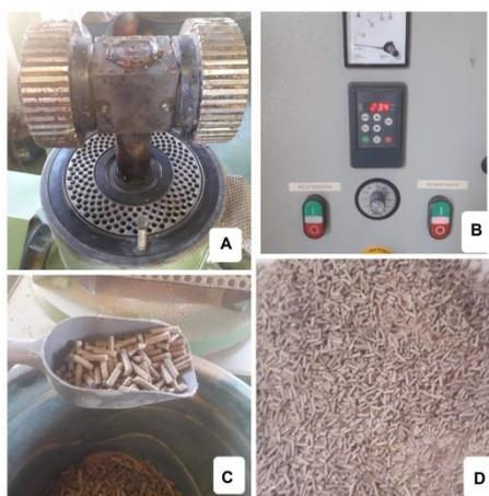
Figura 13. Processo de produção dos pellets: A) matriz com forma circular com orifícios de 6 mm de diâmetro. B) comando de alimentação. C) formação dos pellets. D) pellets em resfriamento.
