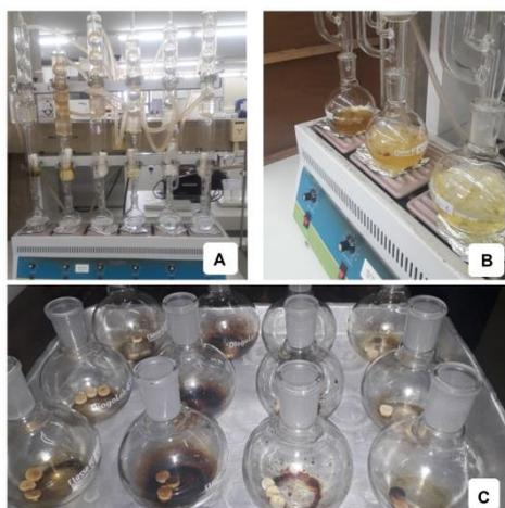
Figura 9. Retirada dos extrativos dos resíduos. A) extrator. B) processo de extração. C) balões com extrativos (girassol, algodão, soja e feijão) após secagem.
