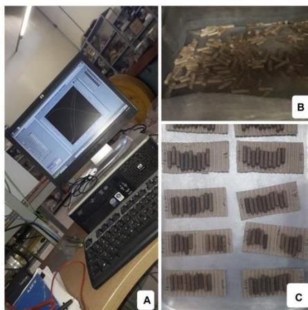
Figura 15. Produção dos pellets torrados: A) determinação dos patamares de torrefação. B) pellets no interior do reator. C) pellets torrados de soja.
