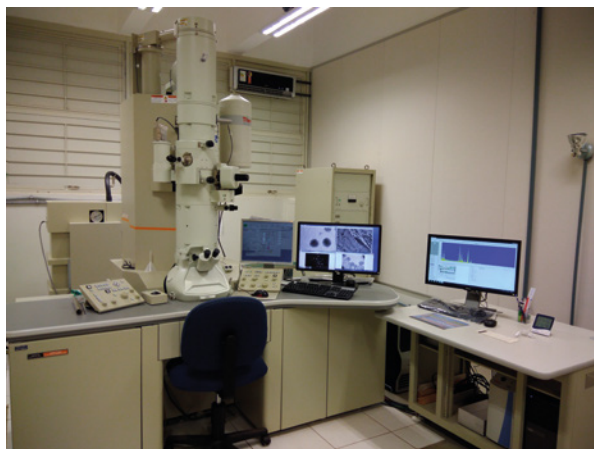
Figura 10: Microscópio eletrônico de transmissão (MET) instalado no LabMic/UFG
