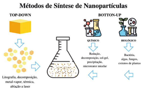
Figura 3: Esquema ilustrativo dos métodos de obtenção das AuNPs
