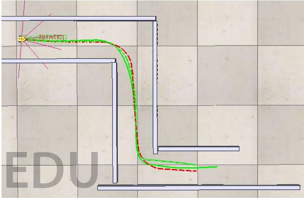
Figura 25 – Cenário de teste para treinamento do *referee*. O robô se move em um corredor duplo em forma de L Vermelho: trajetória demonstrada. Verde: trajetória imitada. Os detalhes do processo de imitação podem ser vistos em <https://youtu.be/HFh8zHNB0SY>
